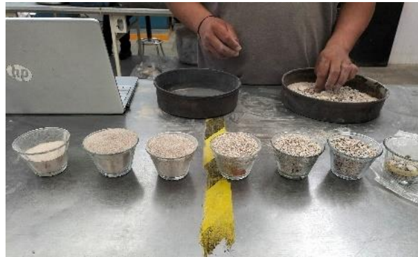
Figura 29. Análisis granulométrico del agregado fino, vista en planta (a), vista lateral (b).
