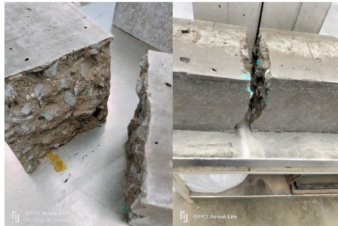
Figura 66. Adherencia de las vigas fibratadas con PEAD en proporción de 2.5% de 1.5x30mm.
