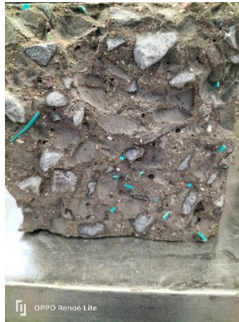
Figura 45. Se muestra la adherencia de las fibras 2x20mm.
