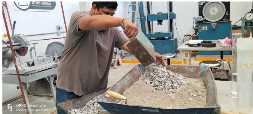
Figura 68. Mezclado manual del concreto con PEAD.
