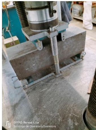
Figura 41. Ensayo de resistencia a flexión de vigas fibratadas con 5% PEAD en 2x20mm.
