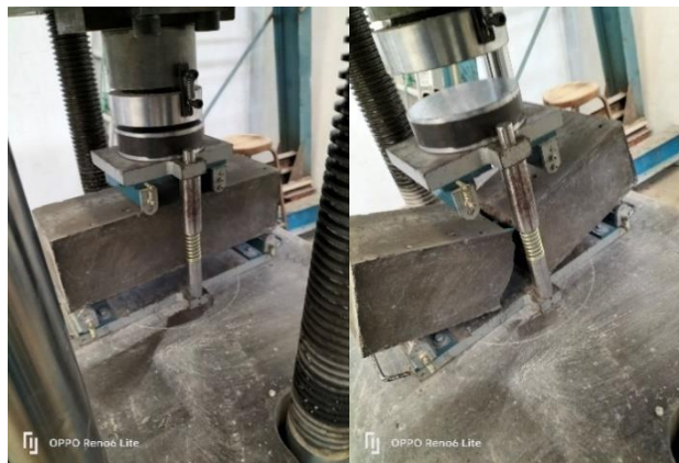
Figura 39. Ensayo de resistencia a flexión de vigas fibradas con 2.5% PEAD en 2x20mm.
