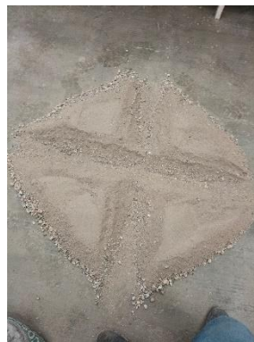
Figura 27. Ensayo de peso volumétrico del agregado fino.
