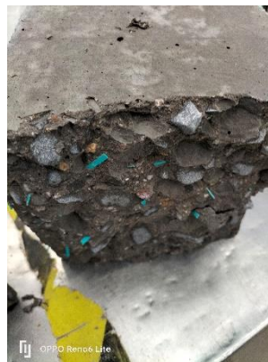
Figura 54. Se muestra la adherencia de las fibras 4x20mm.
