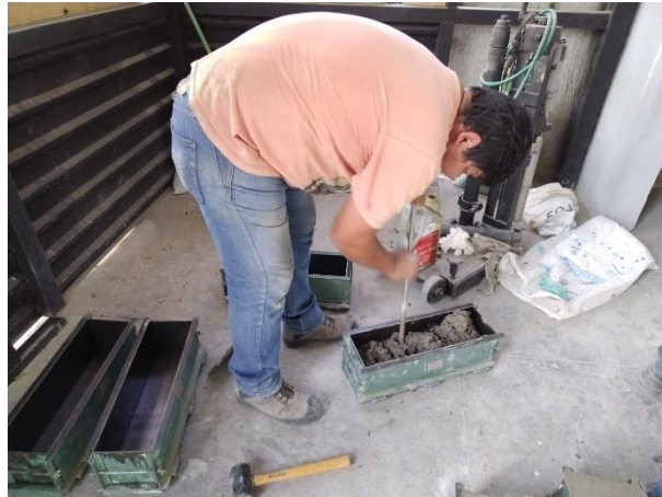
Figura 73. Elaboración de vigas de concreto con fibras de PEAD
