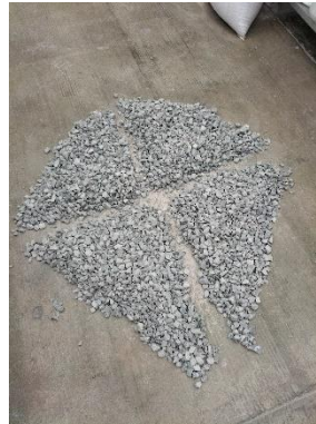
Figura 21. Muestreo y cuarteo del agregado grueso para su PV.
