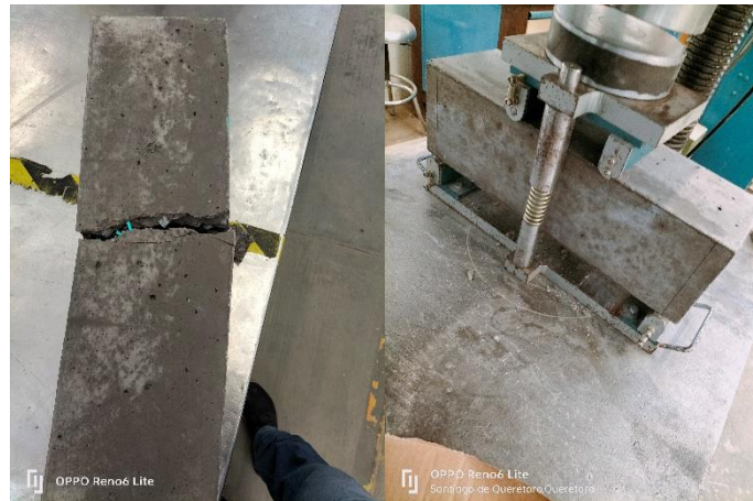
Figura 61. Ensayo de resistencia a flexión de vigas fibratadas con 7.5% PEAD en 6x20mm.
