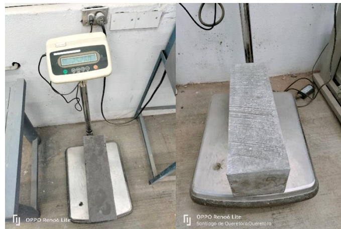
Figura 64. Determinación de pesos volumétricos para vigas con fibras de 6x20mm.
