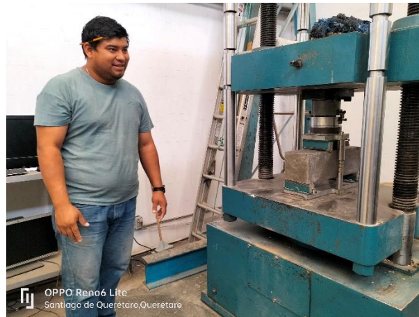
Figura 52. Ensayo de resistencia a flexión de vigas fibratadas con 7.5% PEAD en 4x20mm.
