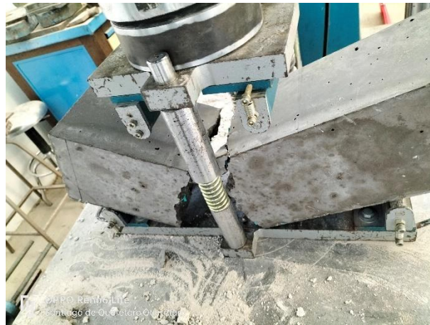
Figura 43. Ensayo de resistencia a flexión de vigas fibratadas con 5% PEAD en 2x20mm.
