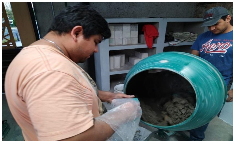
Figura 69. Mezclado mecánico del concreto con PEAD.
