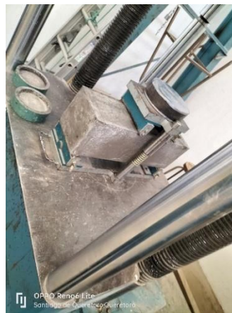
Figura 50. Ensayo de resistencia a flexión de vigas fibratadas con 5% PEAD en 4x20mm.
