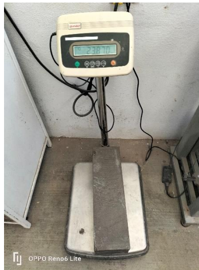
Figura 46. Determinación de pesos volumétricos para vigas con fibras de 2x20mm.
