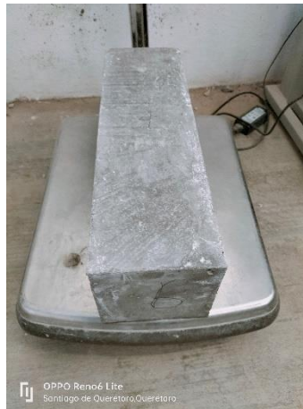
Figura 55. Determinación de pesos volumétricos para vigas con fibras de 4x20mm.
