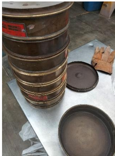
Figura 24. Ensayo granulométrico del agregado grueso.
