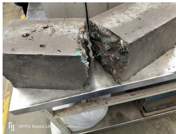
Figura 59. Ensayo de resistencia a flexión de vigas fibratadas con 5% PEAD en 6x20mm.
