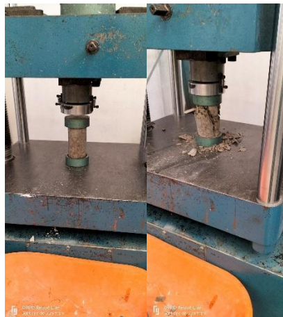
Figura 35. Ensayos de resistencia a compresión de los cilindros de concreto.
