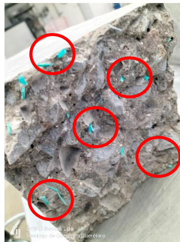
Figura 76. Sección de viga homogeneizada con PEAD.
