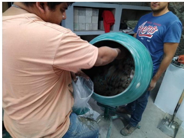
Figura 72. Adición de PEAD en la mezcla de concreto.
