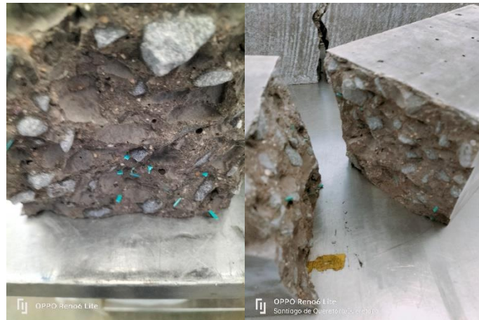
Figura 63. Se muestra la baja adherencia de las fibras 6x20mm.
