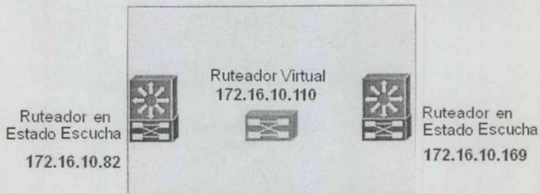
Figura 6.19. Estado escucha de HSRP.
