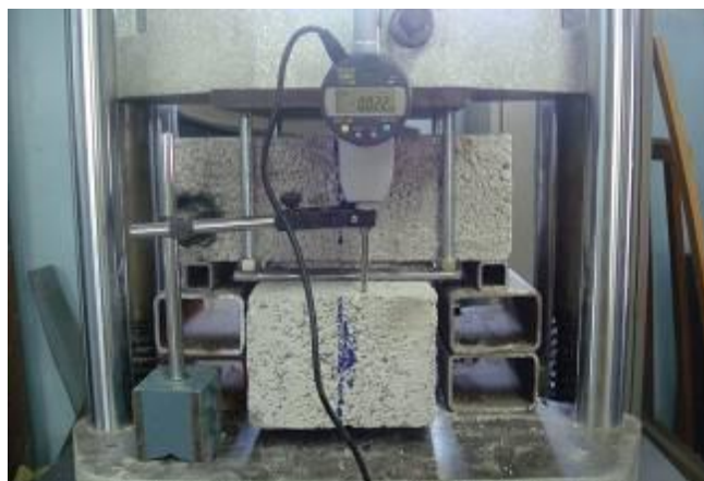
Ilustración 15. Dispositivo para prueba de adherencia, Modelo B.
