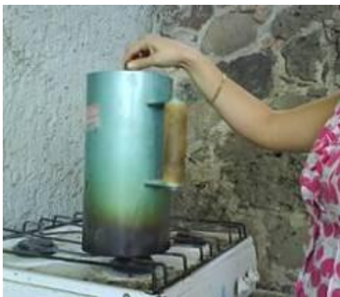
Ilustración 25. Cabeceo de los cilindros de mortero para la prueba a compresión.
