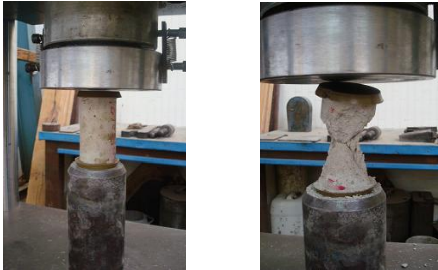
Ilustración 8. Ensaye a compresión de los morteros.
