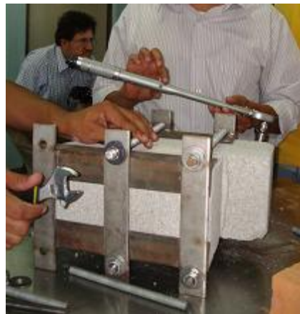
Ilustración 13. Confinamiento del dispositivo con ayuda el torquímetro.
