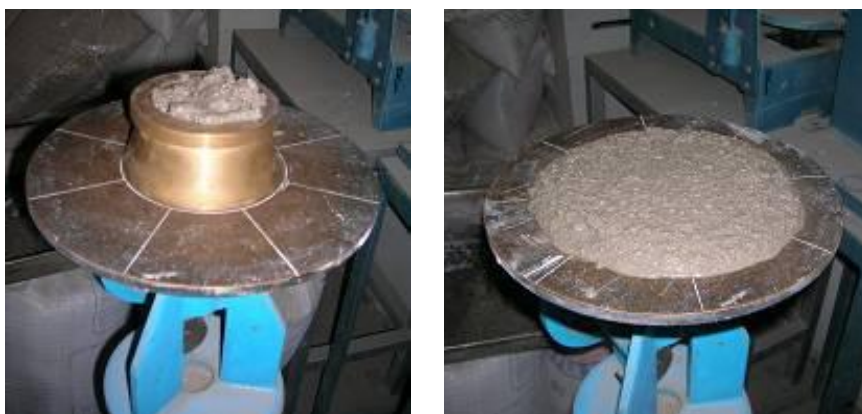
Ilustración 9. Ensayo de la retentividad del mortero.
