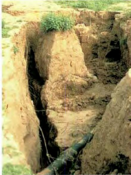
**Figura II.4. Tubería de gas natural expuesta en una grieta, el estudio de la tubería indicó que estaba sometida a tensión (GALLOWAY et al., 1999).**
