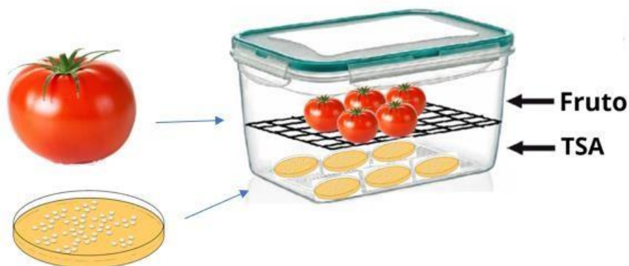
Figura 13: Modelo de ensayo de antagonismo por compuestos volátiles en fruto. Un recipiente plástico mantiene los COV producidos por las cepas bacterianas sembradas en la parte inferior (medio TSA). En la parte superior se sitúa el fruto mantenido por una rejilla.
