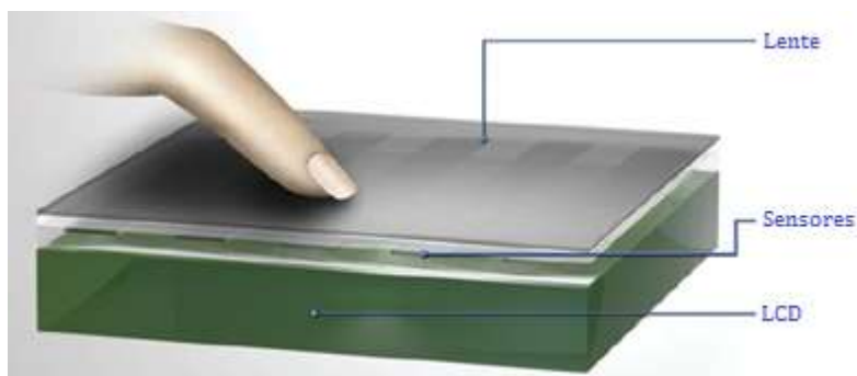
Figura 2.13. Pantalla táctil capacitiva
