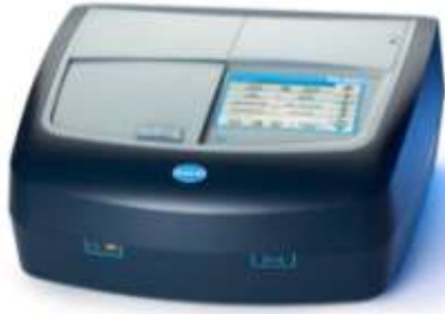
Figura 3.32. Espectrofotómetro HACH DR/6000 utilizado para las mediciones de calidad de agua
