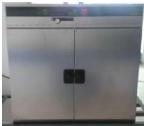
Figura 3.23. Horno de secado marca Memmert modelo 100 – 800 del Laboratorio de Bioingeniería
