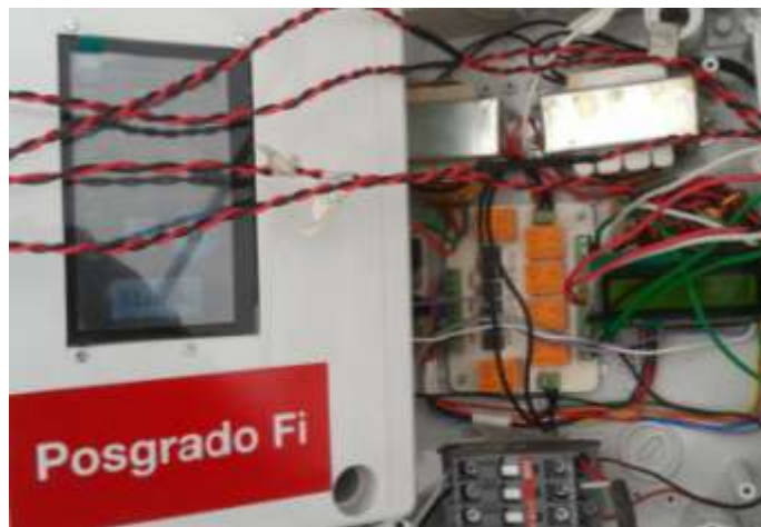
Figura 3.24. Sistema de control de temperatura y fotoperiodo artificial conectado
