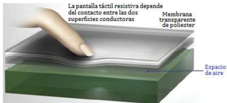
Figura 2.12. Pantalla táctil resistiva
