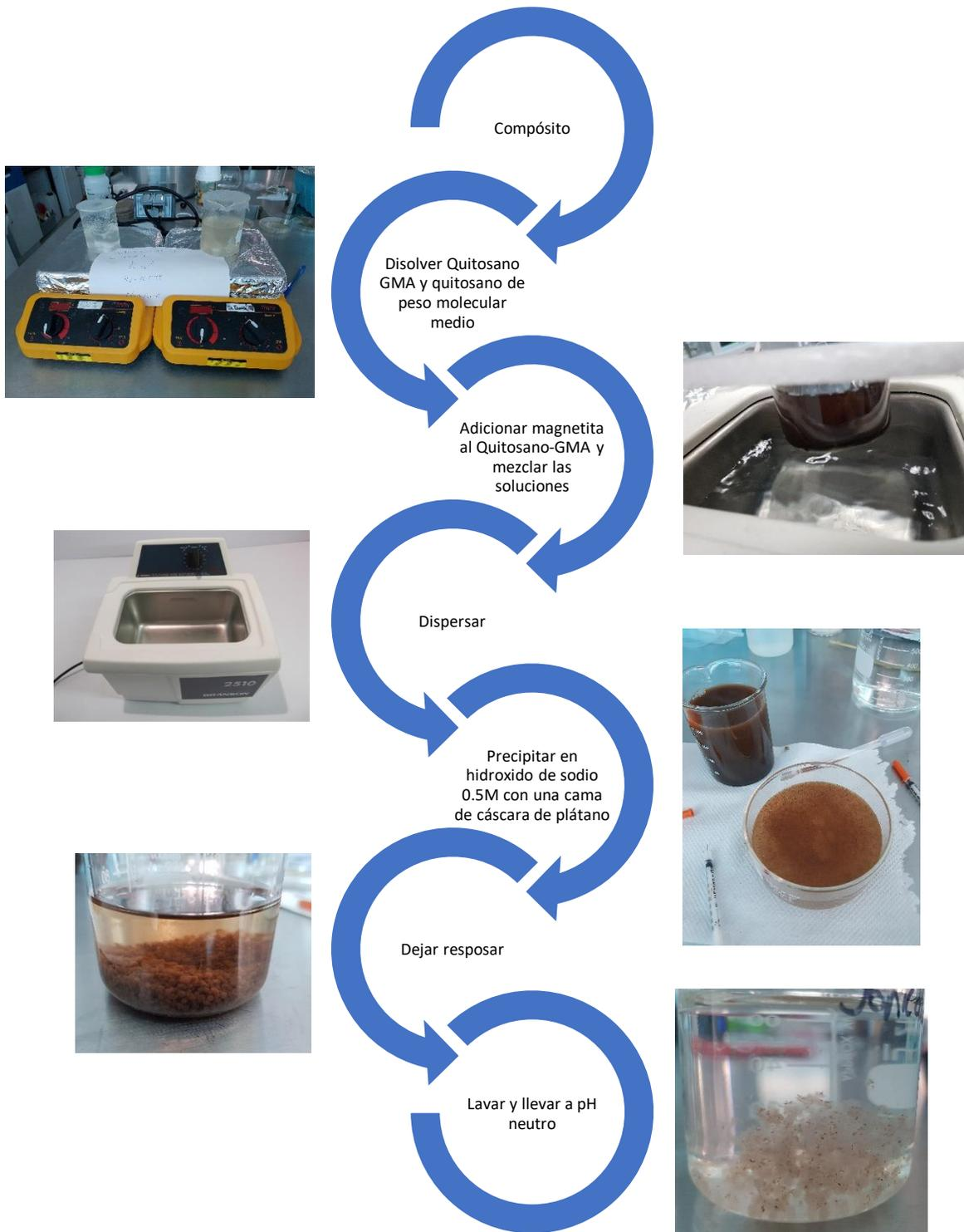
Figura 4.4. Diagrama de la metodología empleada para la elaboración del nanocompósito.
