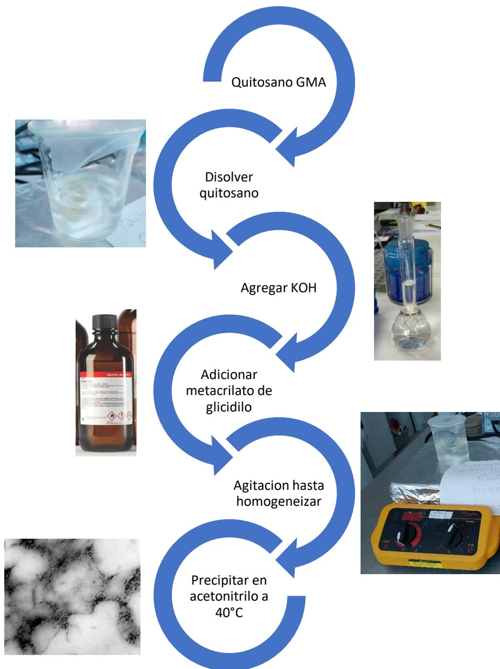
Figura 4.1. Diagrama de la metodología empleada para la síntesis del Quitosano-GMA.
