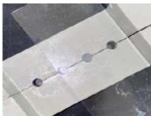
Figura 4. Portaobjetos sobre el molde con espécimen terminado
