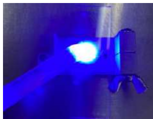
Figura 3. Fotopolimerizado de resina
