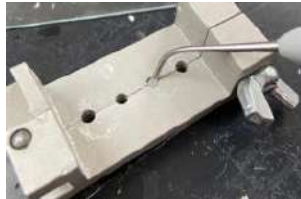
Figura 2. Empacamiento de resina en molde con espátula
