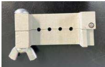
Figura 1. Molde prediseñado de acero para fabricación de los especímenes
