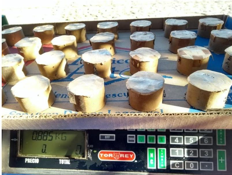
Figura 33. Peso del cuerpo del panel.
