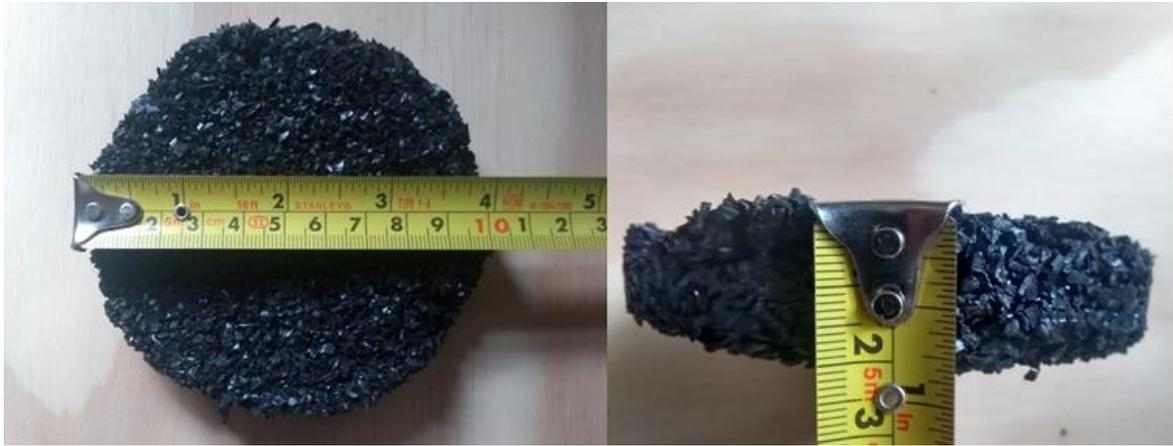
Figura 27. Muestra obtenido de la mezcla de migas de caucho y resina polivinílica.
