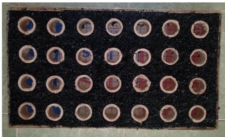
Figura 39. Resultado final de panel acústico hueco relleno con mezcla de caucho-resina peso aproximado
