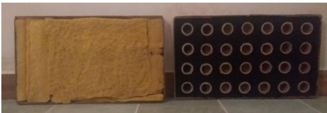
Figura 44. Panel a base de esponja de poliuretano (EP) y panel de caucho granular (CG).
