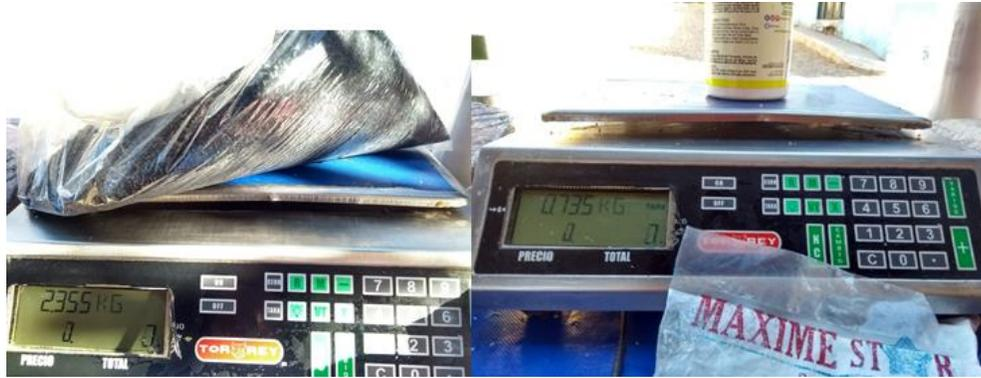
Figura 34. Pesado de los materiales de la mezcla caucho-resina.
