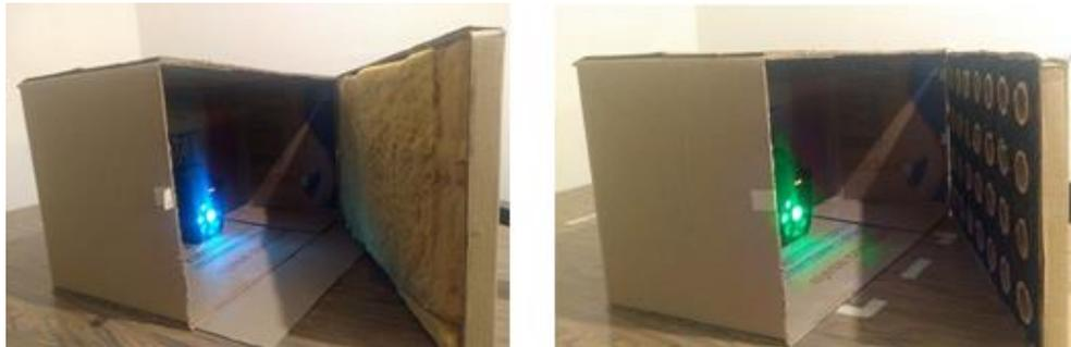
Figura 47. Colocación la fuente de ruido y de ambos paneles.
