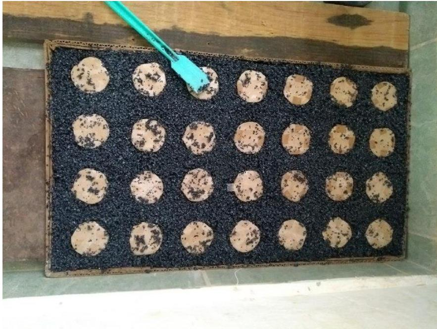
Figura 37. Panel de caucho terminado de fraguar.
