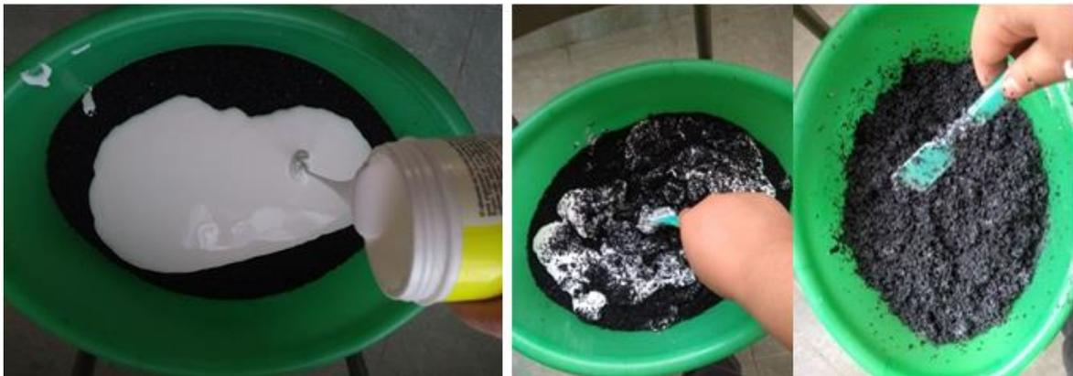
Figura 35. Combinación de la mezcla caucho granular y resina.
