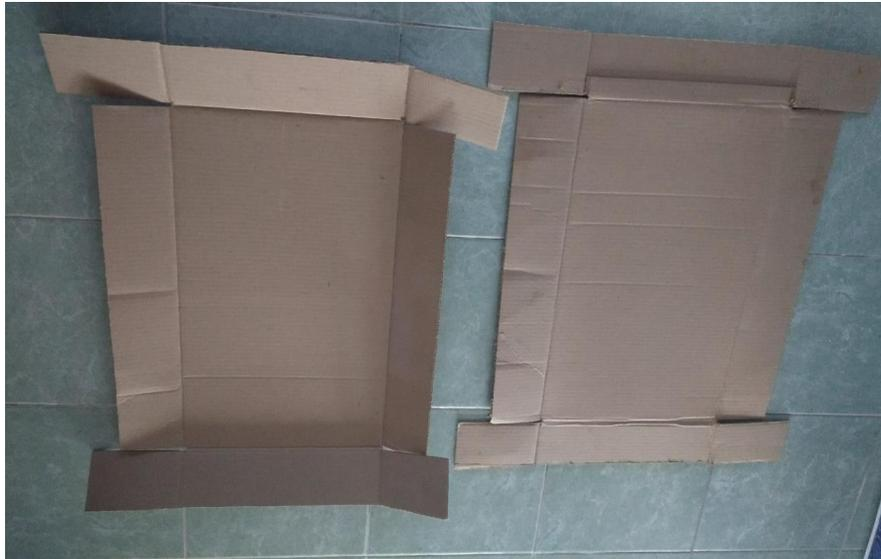
Figura 31. Base del panel acústico con medidas de 61x36x3 cm.
