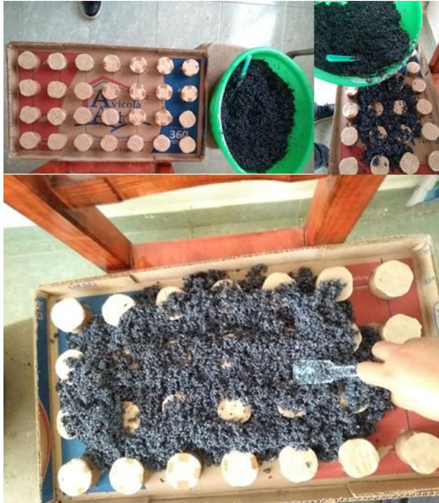
Figura 36. Vaciado de la mezcla en la base del panel.
