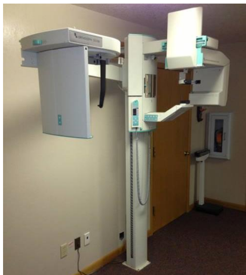
Fig. 8 Ortopantomografo digital rayos X digital 3d Vatech Pax-i 3d Smart Sc 10x8.5 cbct, panorámico y lateral de cráneo.
