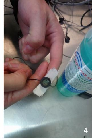
Fig. 4 Colocación del gel conductor en el electrodo de superficie
