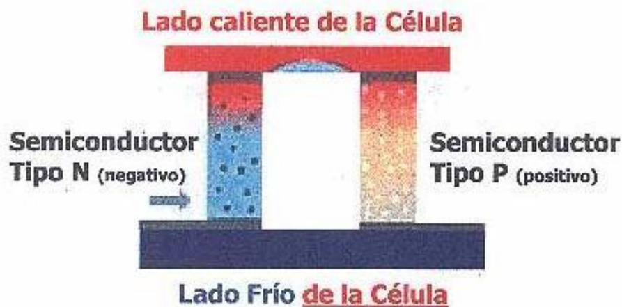
Figura 2.6 Esquema de funcionamiento de una célula peltier (Mundo digital, 2018).
