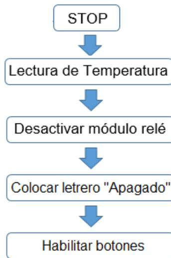
*Figura 4.25 Diagrama de flujo condición de "STOP".*
