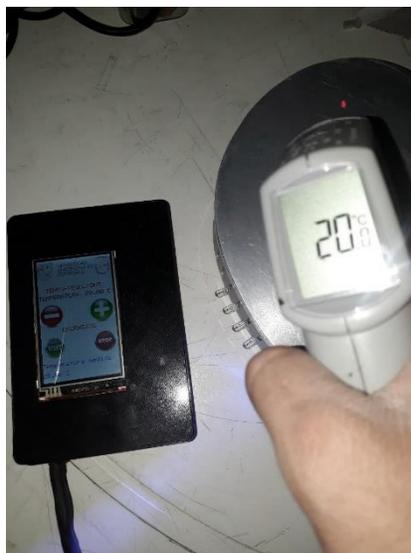
Figura 4.35 Medición de temperatura con termómetro láser.
