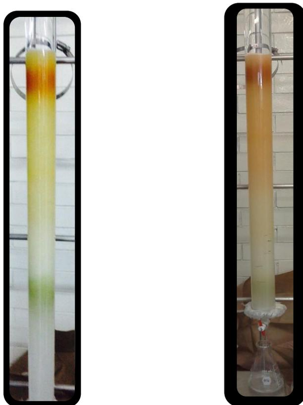
**Figura 15.** Cromatografía en columna abierta a la que fue sometida la fracción concentrada de alcamidas (FCA).
