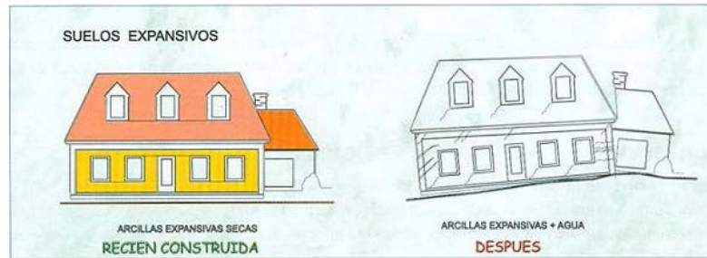
Figura 1.2 Movimientos diferenciales en estructuras civiles causados por arcillas expansivas.
