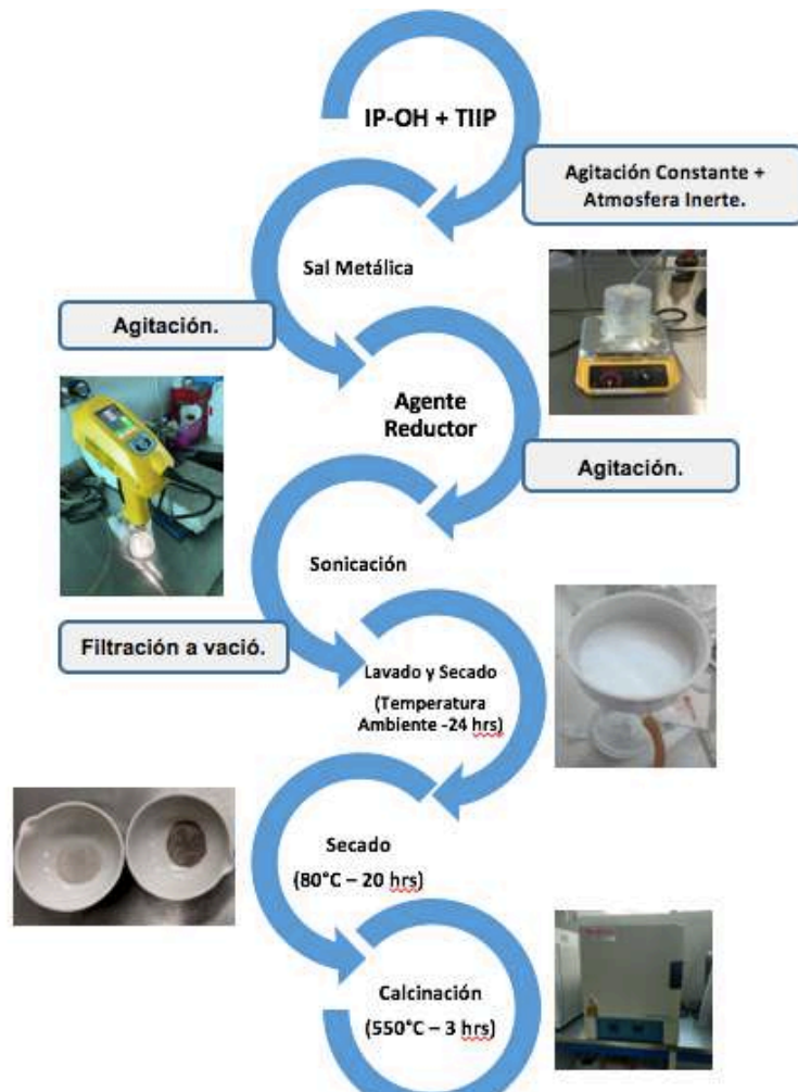
Figura 8. Diagrama de la metodología empleada para la síntesis del material \text{TiO}_2 -Pt.
