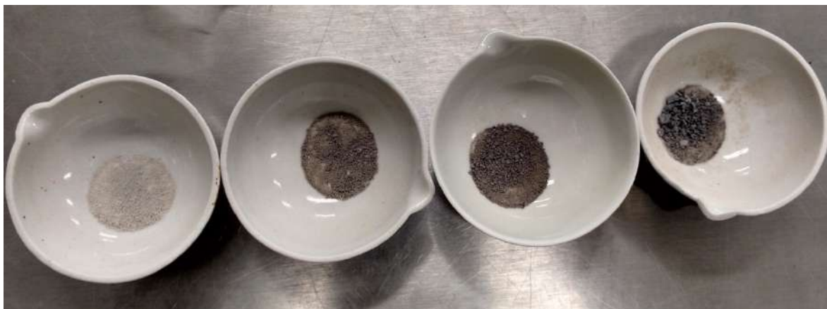
Figura 9. Muestras de \text{Pt-TiO}_2 a diferentes concentraciones de platino después de la calcinación a 550°C.
