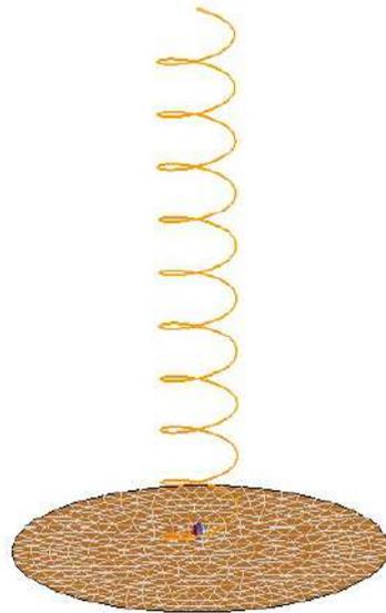
Figura 3.26: Modelo 3D de antena de hélice. ([Altair Engineering, 2018a](#))
