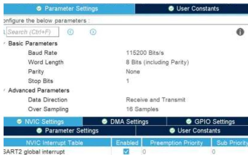
Configuración de interrupciones: para que la comunicación UART no bloquee el procesamiento se utilizan interrupciones. En este caso, la interrupción UART está configurada para activarse cuando se reciben datos. Esto asegura que el microcontrolador procese rápidamente los datos entrantes desde la computadora personal. Y que no se desperdicie procesamiento verificando si hay mensajes disponibles por medio de polling.
