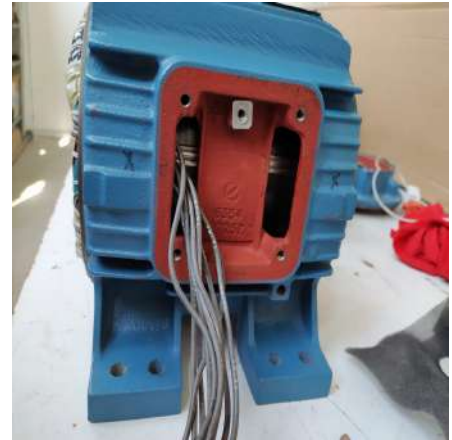
(d) Vista lateral, caja de bornes del MI físico.
