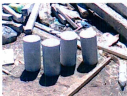
Fig. 30 Descimbrado y fraguado de cilindros de concreto
