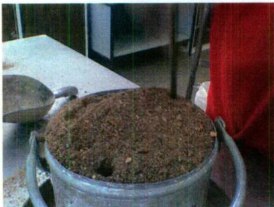
Fig.4 una vez llenado el recipiente se le aplican los 25 golpes (piquetes) para compactar el material (para las pruebas de material suelto no se aplican los 25 golpes simplemente se deposita el material en el recipiente).
