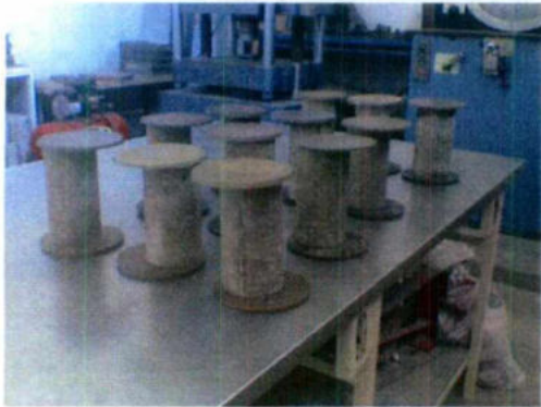
Fig. 26 Cilindros cabeceados para la prueba de compresión.
