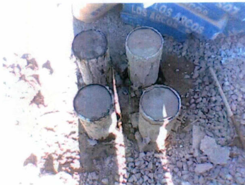
Fig. 28 Cilindros de concreto de diferentes resistencias hechos en obra
