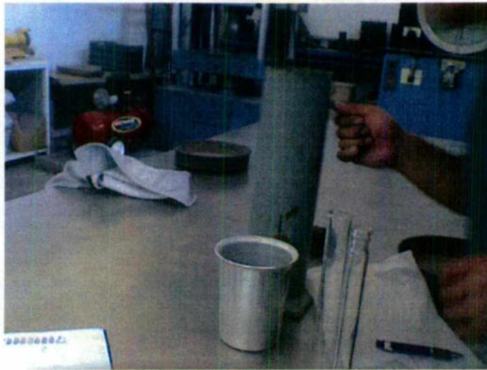
Fig. 9 se coloca la muestra en el tronco-cónico para su saturación.
