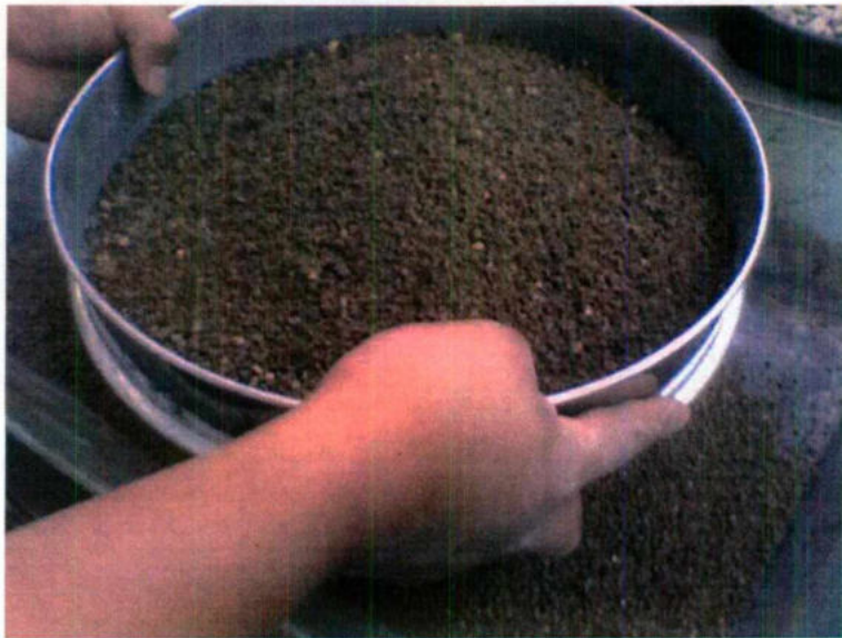
Fig. 7 Se criba la arena por la malla No.4 para obtener una muestra de arena.
