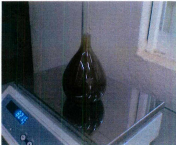
Fig. 9 obtención del peso del matraz y muestra saturada.
