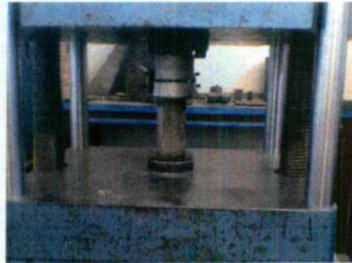
Fig. 26 Cilindros cabeceados para la prueba de compresión.
