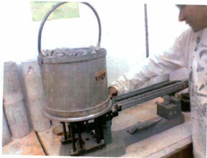
Fig. 6 se pesa el material (este procedimiento es para ambas condiciones suelto y compactado).
