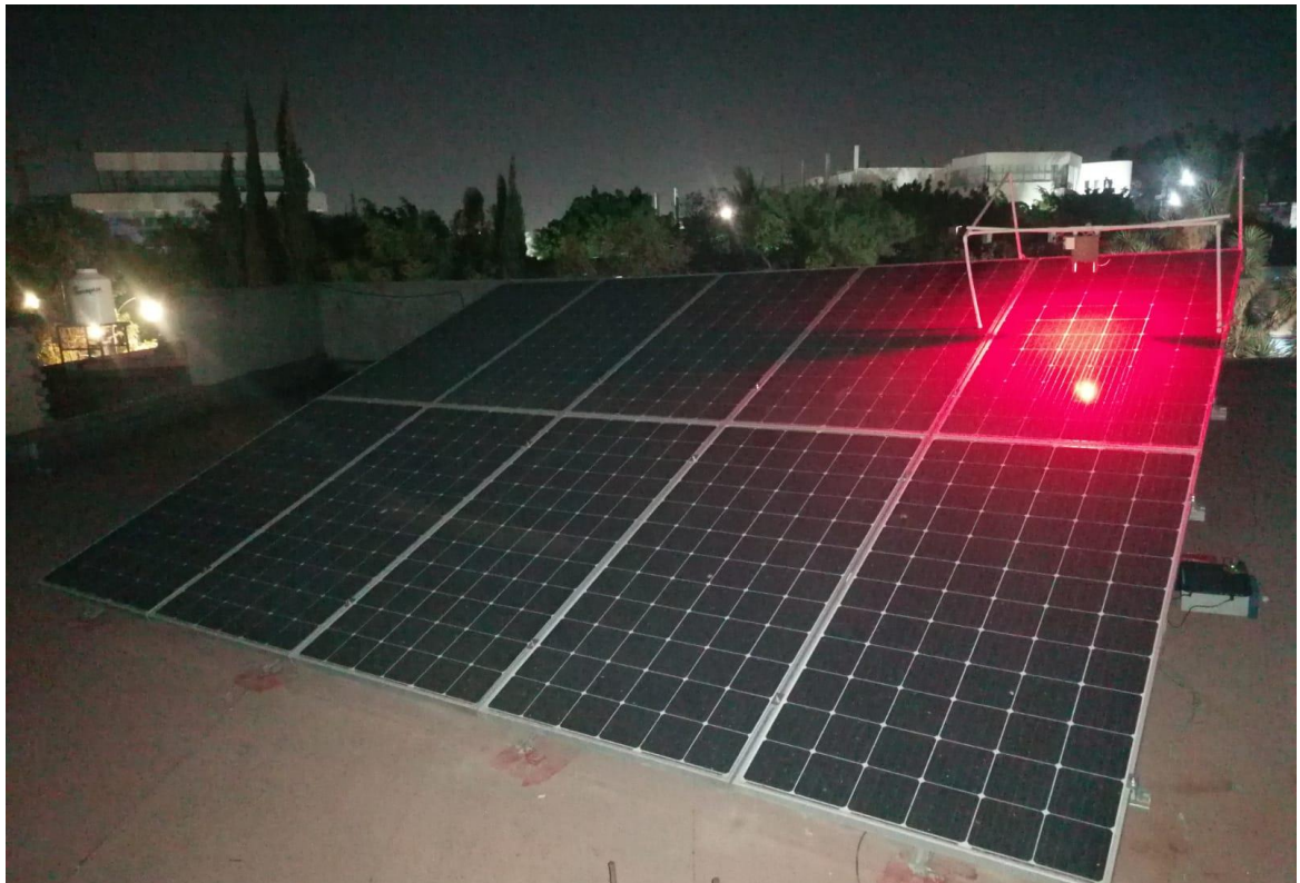
Imagen 9: Comprobación experimental del método OCF en SFVI.
