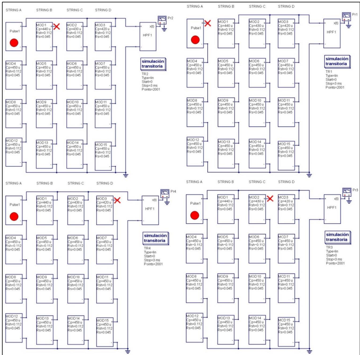
Figura 19: Ejemplificación OCF de arreglo 4x4 en QUCS.
