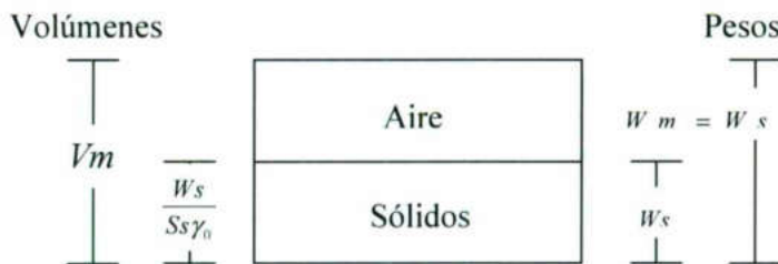
Fig. VI.3.2 Esquema que ilustra la obtención del límite de contracción según Terzaghi. (J. Badillo y R. Rodríguez, 1979)
