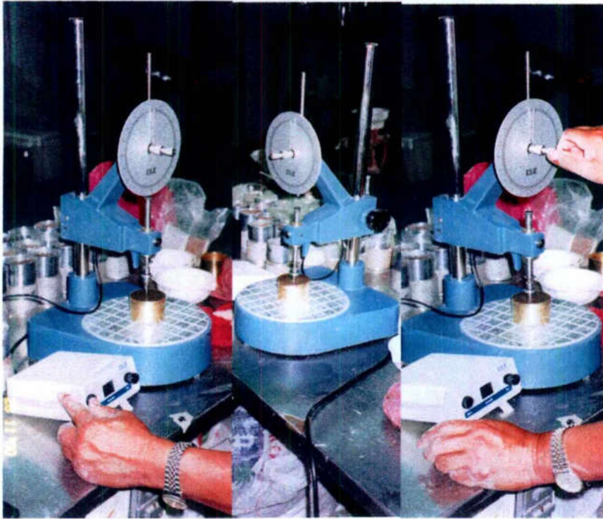
a) Colocación e inicio de la prueba b) Penetración del cono c) Medición de la penetración
