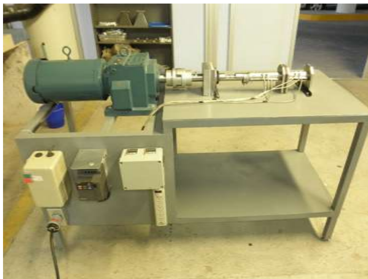
Figura 8 Extrusor de tornillo simple, de propósito general para alimentos. ( Fuente: Imagen propia)
