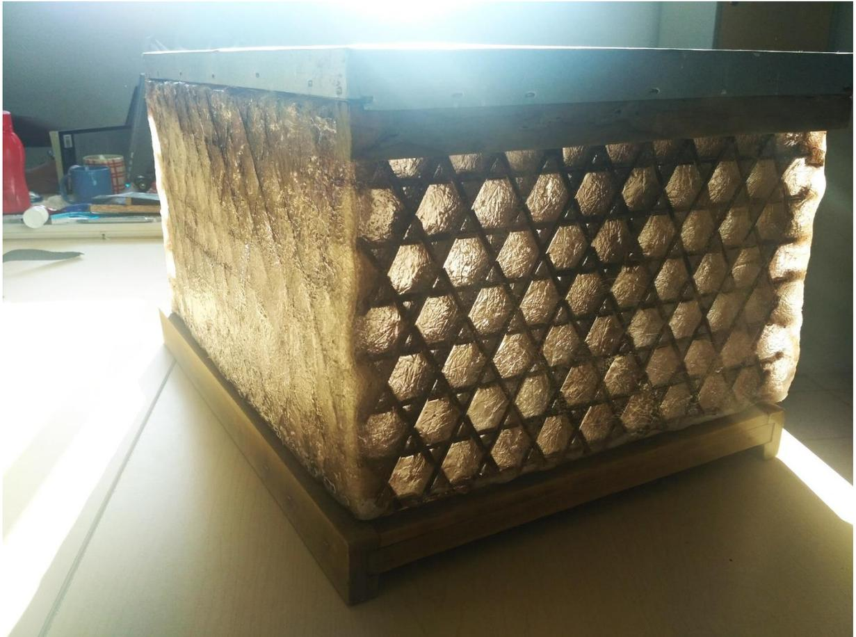
*Figura 40 Colmena completa con cámara de cría Quarter isogrid recubierta con resina y fibra de vidrio*
