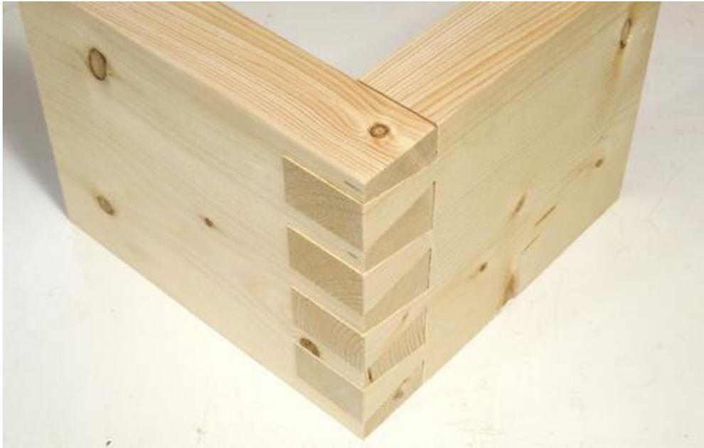
Figura 8 Ensamble tipo cola de milano Fuente: (woodgears, 2018)
