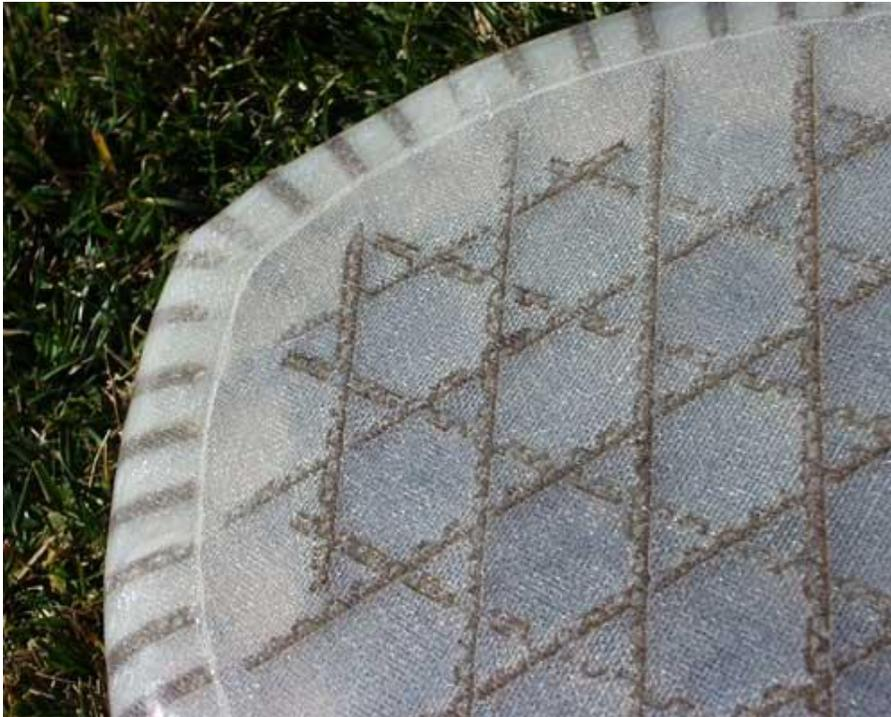
Figura 19 Fotografía de la nariz de una tabla de surf hecha de un núcleo de matriz Quarter isogrid de cartón. Fuente: (Sheldrake, 2018)
