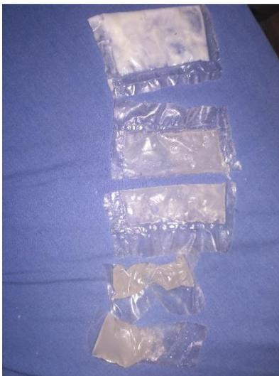
*Figura 27 CaCl<sub>2</sub>·6H<sub>2</sub>O Encapsulado en plástico*
