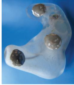
Figura 2.4: Electrodo de Ear-EEG [Kidmose et al., 2013]
