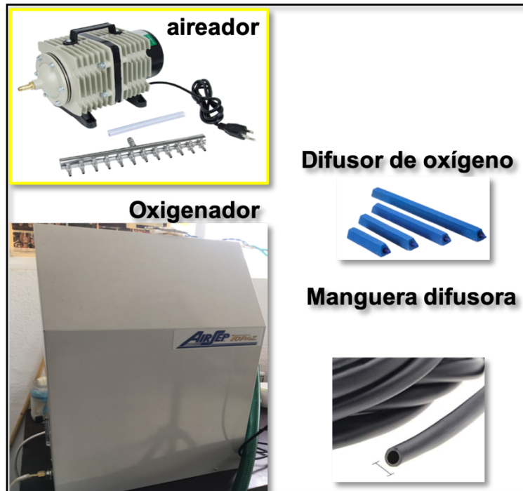
Figura 5. Esquema de los equipos y materiales de los sistemas de oxigenación y aireación (Elaboración propia)
