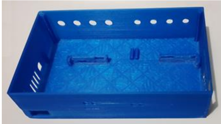
Figura 20 Fotografía de base del sistema impresa en PLA
