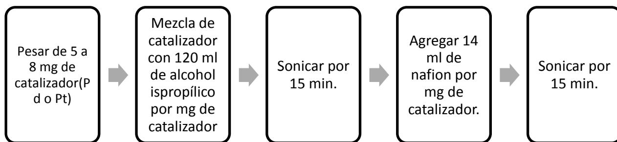
Figura 8.- Diagrama de elaboración de tintas catalíticas
