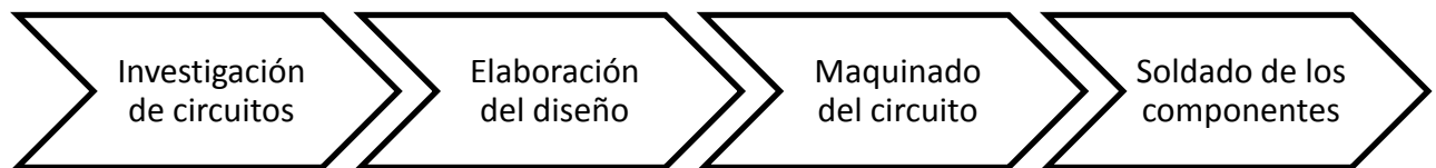
Figura 10.- Diagrama de elaboración del circuito microelectrónico.
