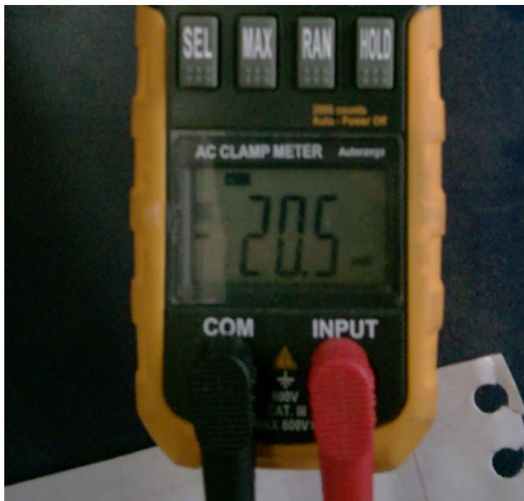
Figura 42. Valor de voltaje con el motor detenido.
