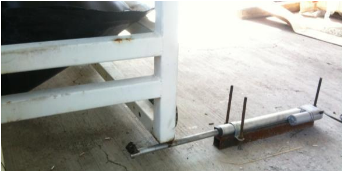
Figura 3.8. Mecanismo electromecánico para el mezclado.
