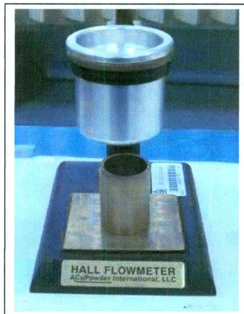
Figura 12. Aparato de Hall utilizado para la medición de fluidez y densidad aparente de polvos.
