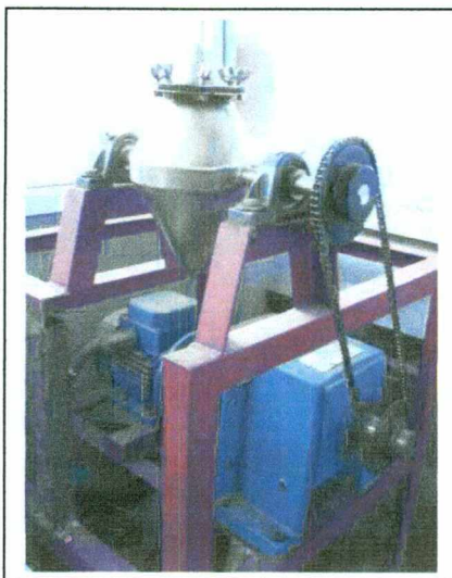
Figura 13. Mezclador de doble cono.
