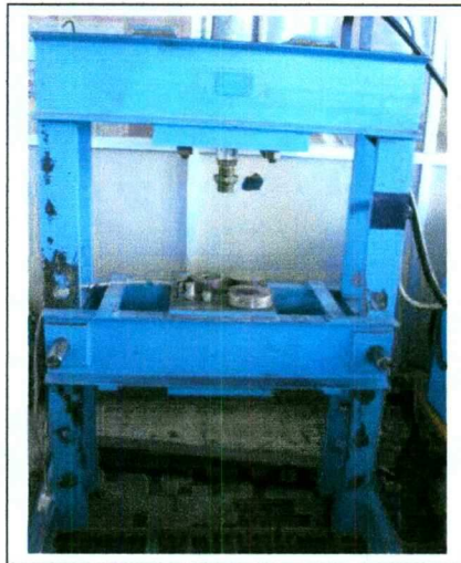
Figura 15. Prensa utilizada para la etapa de compactación.
