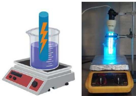
Figura 16. Reactor con lámpara UV para la foto-oxidación de As 3+ .
