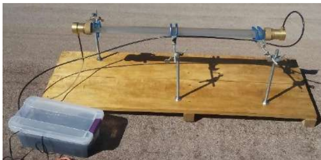
Figura 15. Prototipo solar para la degradación de colorantes.
