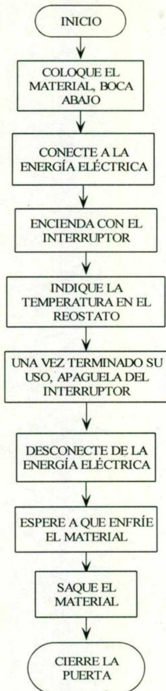
Figura 16. Procedimiento de operación para la estufa
