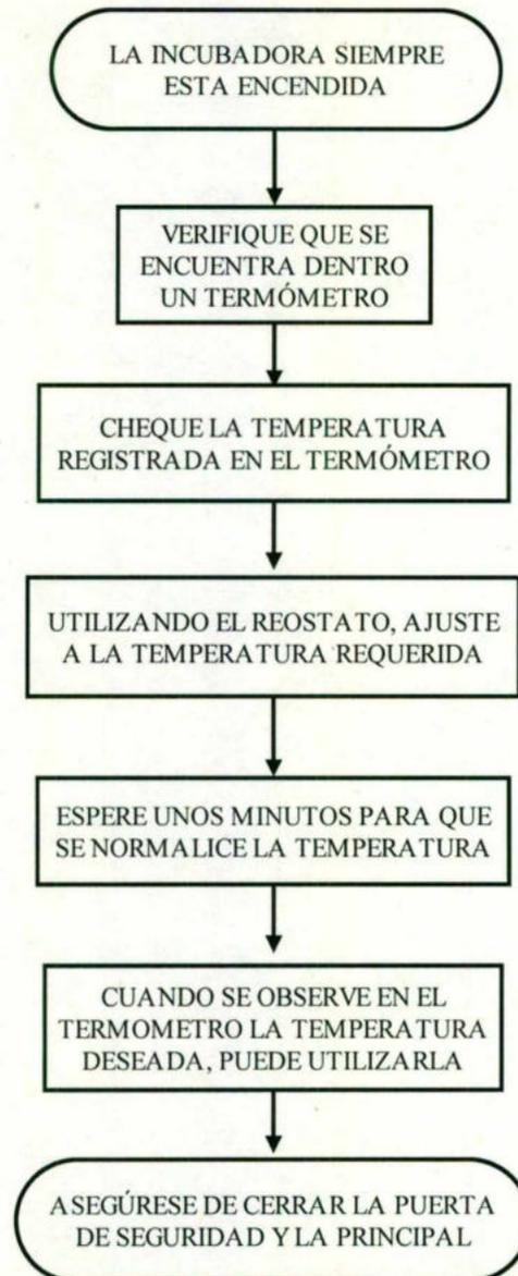
Figura 15. Procedimiento de operación para la incubadora
