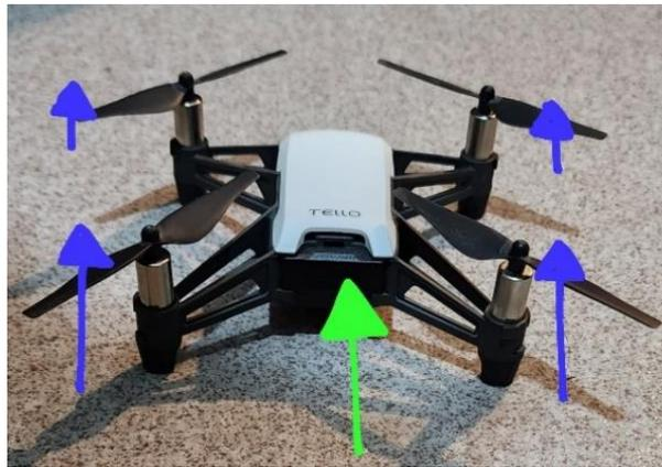
**Figura 27.** Diferencia de velocidad entre los motores delanteros y traseros para desplazar el dron hacia atrás.
