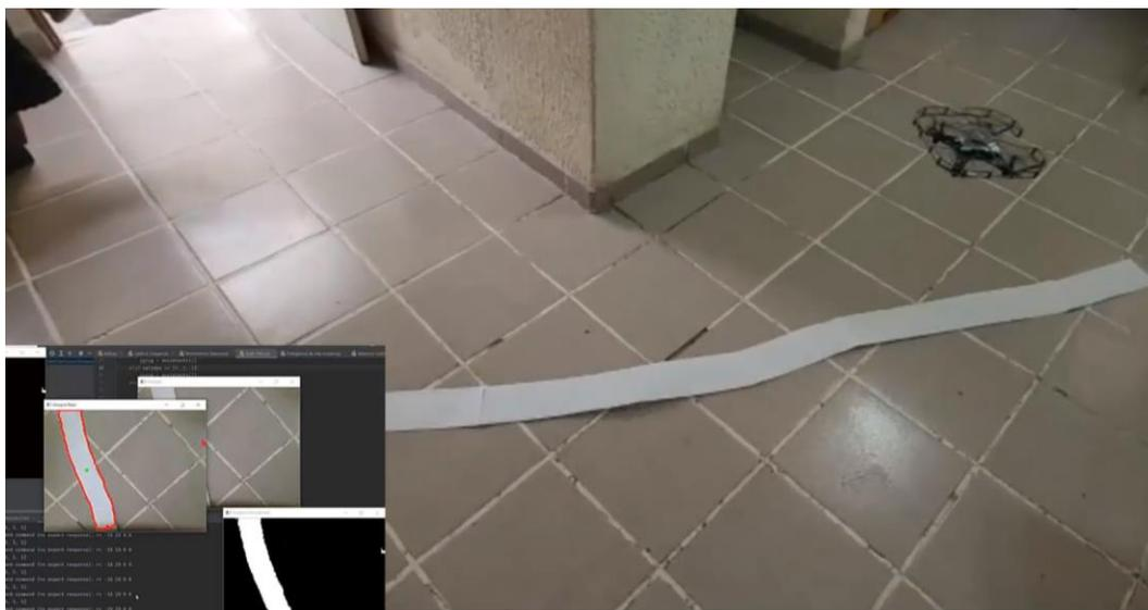
**Figura 50.** Imagen del dron detectando y trasladándose sobre la ruta.
