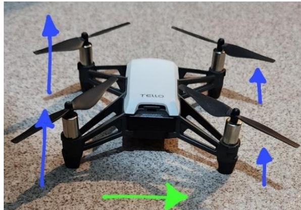
**Figura 24.** Diferencia de velocidad entre los motores para desplazar el dron hacia la derecha.
