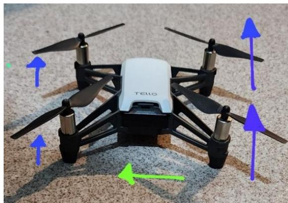
**Figura 25.** Diferencia de velocidad entre los motores para desplazar el dron hacia la izquierda.
