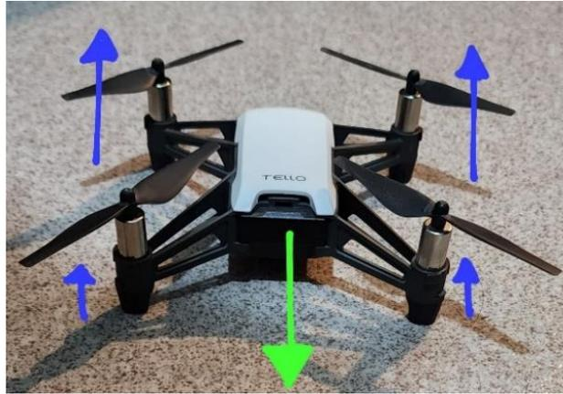
**Figura 26.** Diferencia de velocidad entre los motores delanteros y traseros para desplazar el dron hacia delante.
