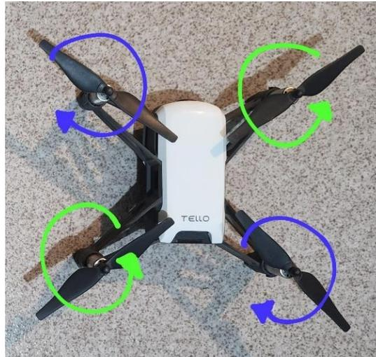
**Figura 23.** Imagen de cómo debe de girar un dron para mantener un momento angular cero.
