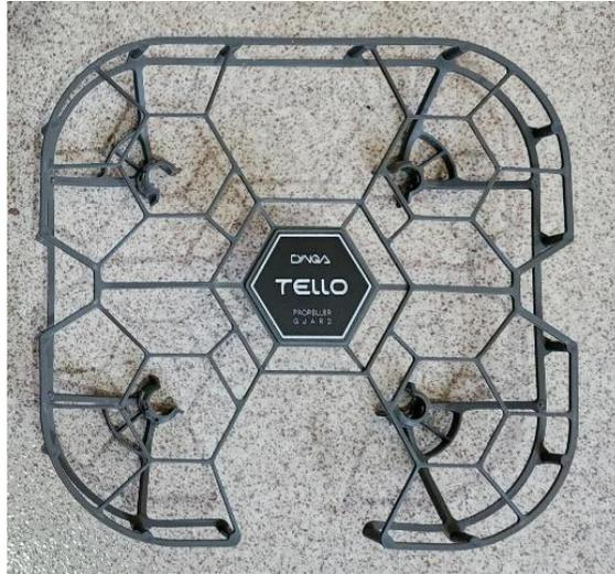
**Figura 37.** Jaula protectora para el dron Tello.
