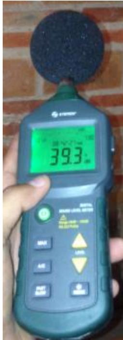
*Figura 4. Sonómetro marca STEREN clase II.*
