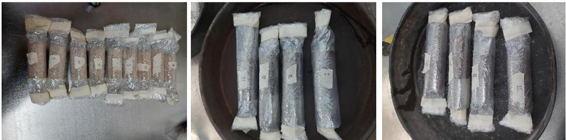
*Figura 5.22 Recubrimiento de las probetas de suelo para evitar la pérdida de humedad.*
