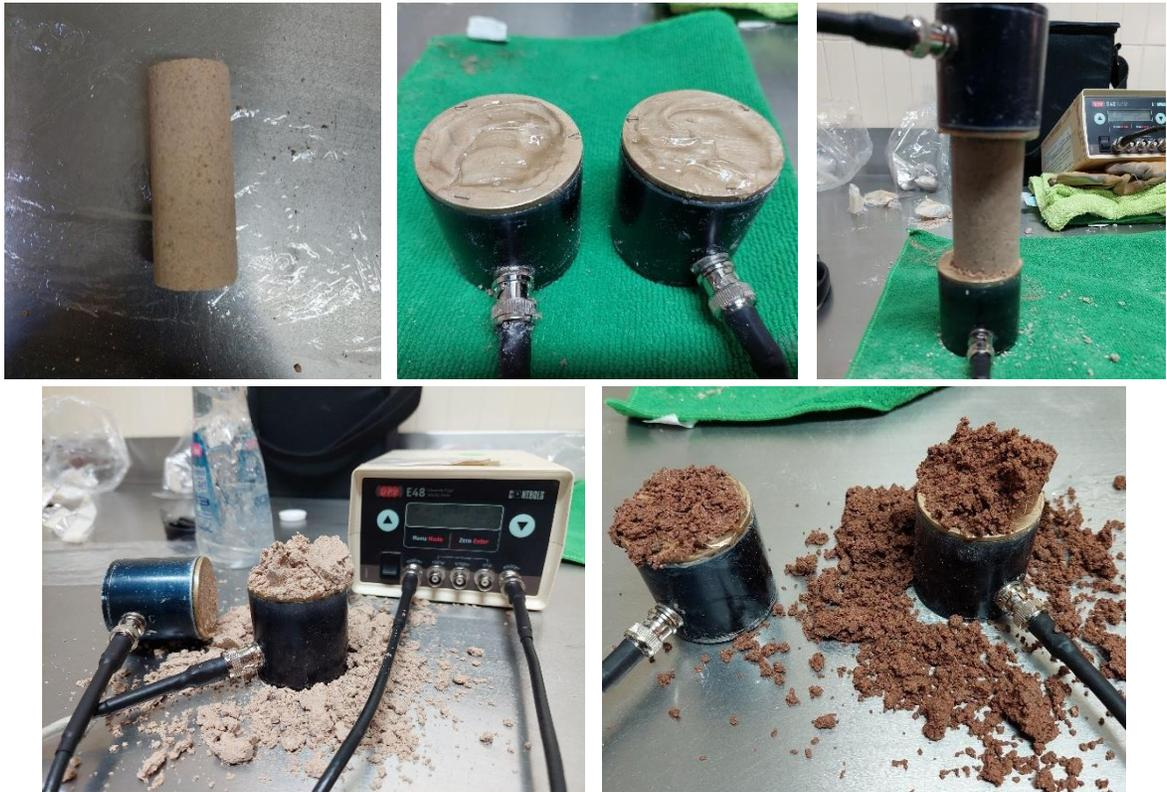
Figura 5.15 Prueba de Velocidad de Pulso Ultrasónico y desintegración de probetas de arena limosa y grava limosa.
