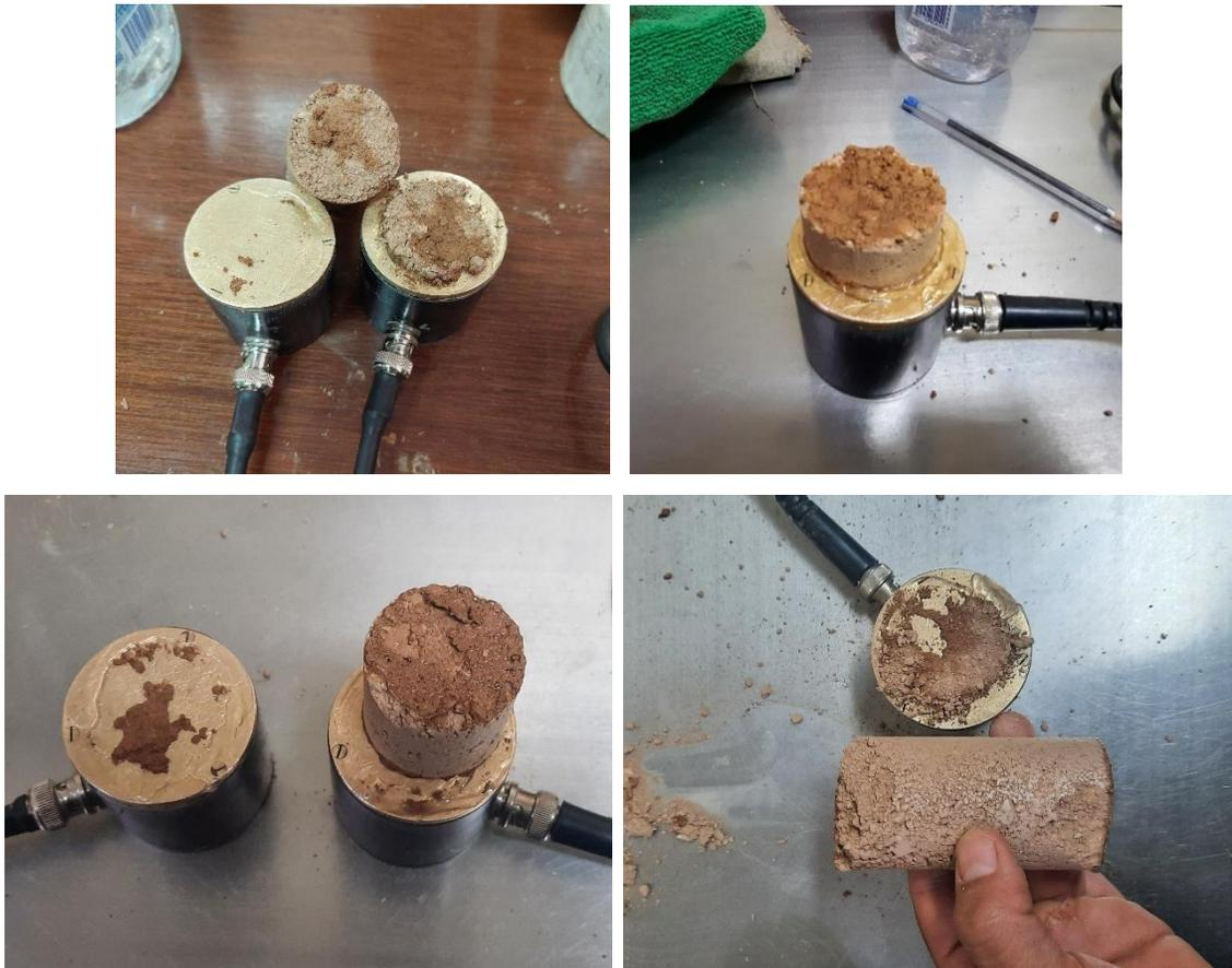
*Figura 6.3 Probetas de limo (ML) después de retirar los transductores (pérdida de la superficie plana de la probeta).*
