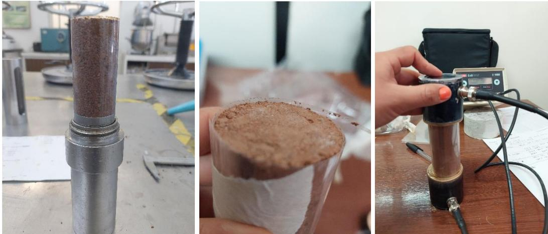
*Figura 5.23 Recubrimiento de las probetas de grava limosa y limo (ML) con hojas de acetato*
