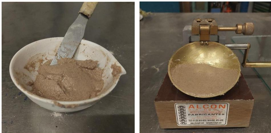
Figura 5.6 Proceso para obtener el límite líquido de los materiales.
