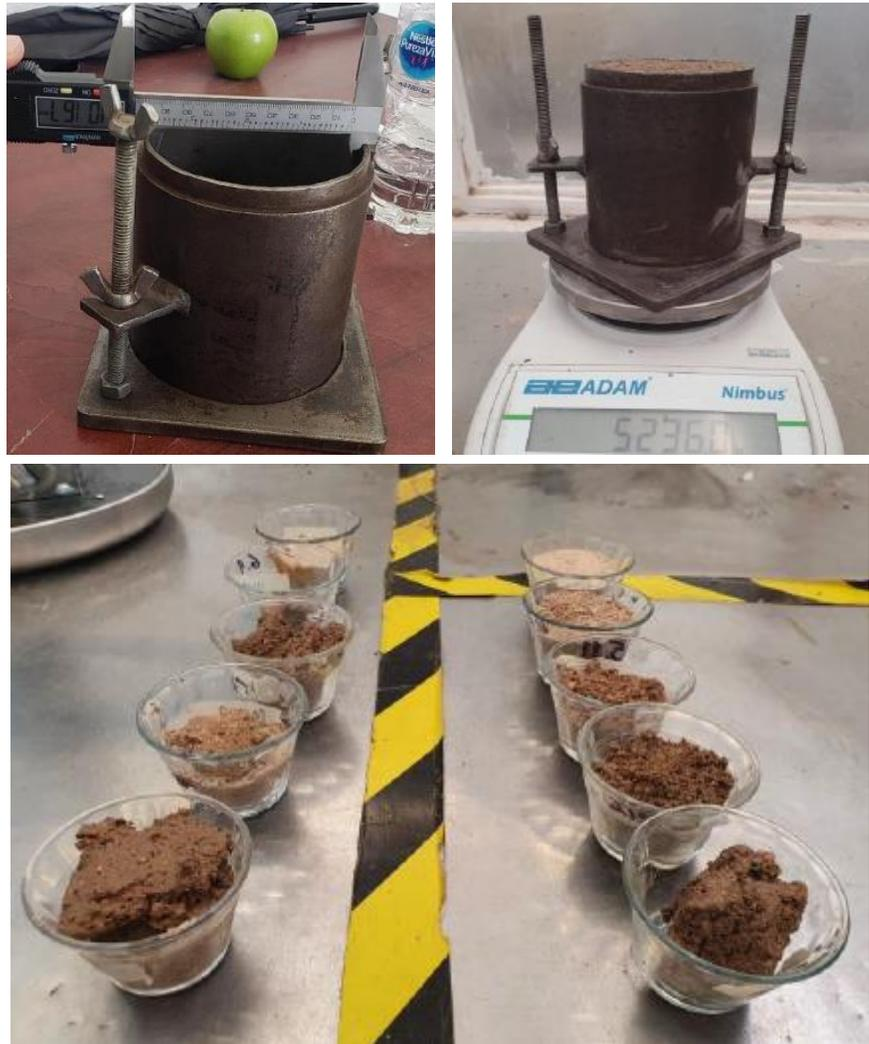
Figura 5.11 Proceso de la prueba de compactación
