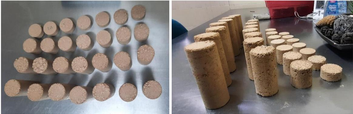
*Figura 5.20 Probetas con diferentes longitudes y peso volumétricos secos con una humedad  $\approx 0\%$ .*
