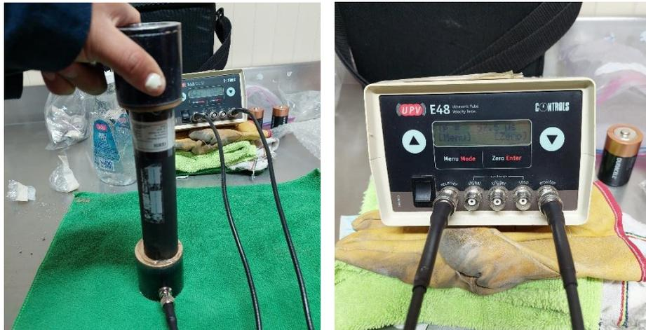
Figura 5.14 Cilindro de calibración. Fuente: Propia.
