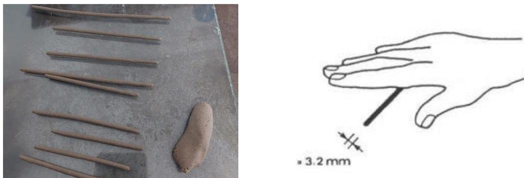
Figura 4.3 Prueba de límite plástico, formación de filamentos. Fuente: propia y Fernández, J. A. G. (2017).
