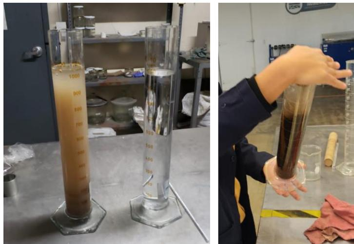
*Figura 5.8 Proceso para obtener la distribución de las partículas a través del hidrómetro.*
