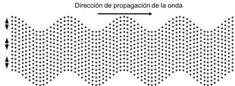
Figura 4.7 Onda secundaria, transversal o de corte. Fuente: Krautkrämer, et al., (1990).
