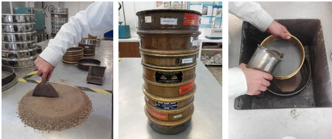
Figura 5.9 Proceso para obtener la distribución de las partículas a través de mallas.
