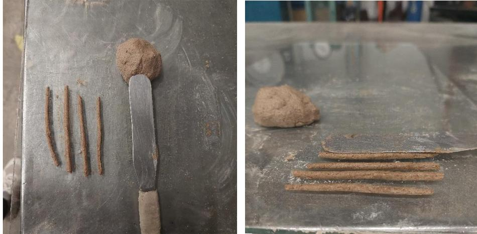
*Figura 5.7 Proceso para obtener el límite plástico de los materiales.*
