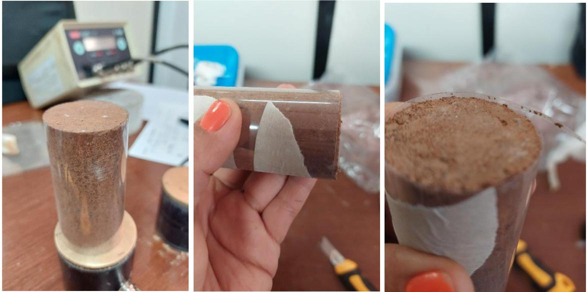
Figura 6.15 Proceso de medición de probetas de limo (ML) de longitud de 74 mm, con una hoja de acetato de confinamiento.
