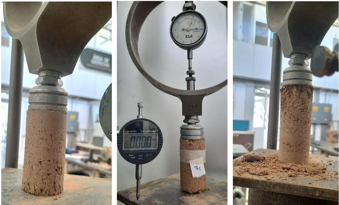
Figura 5.17 Proceso de la prueba de compresión simple, montaje, prueba y falla de una probeta de limo (ML).
