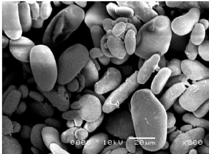
Figura 11. Micrografía electrónica de barrido del almidón nativo de plátano (800X).
