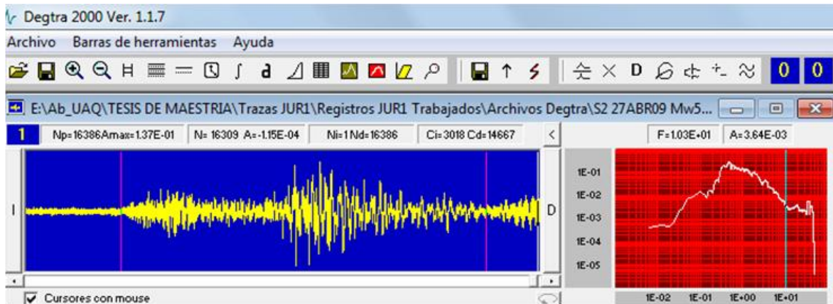
Figura 5.4 Ventana típica de trabajo dentro del ambiente del programa Degtra. Se muestra la estimación de la amplitud espectral de aceleraciones para la frecuencia 10Hz, de la componente NS, del evento No.1, de magnitud Mw=5.6 en estación JUR1. A la izquierda (ventana azul) aparece el acelerograma y a la derecha (ventana roja), el espectro de Fourier de aceleración.
