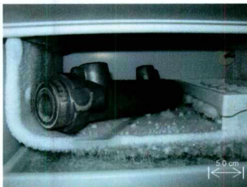
Figura 10. Cilindro maestro en el congelador para disminuir su temperatura.
