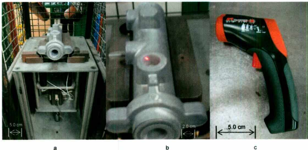
Figura 7. Fotografías que muestran el cilindro maestro suspendido en los transductores (a y b) y el pirómetro láser usado para la toma de temperatura (c).
