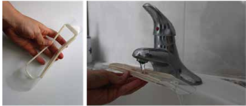
Fotografía 6. Modelo de validación funcional (PET G). Elaboración propia.
