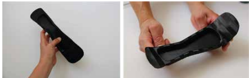
Fotografía 7. Modelo de validación funcional (Filamento flexible). Elaboración propia.
