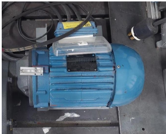
Figura 2.1: Motor de inducción trifásico tipo jaula de ardilla utilizado (autoría propia).
