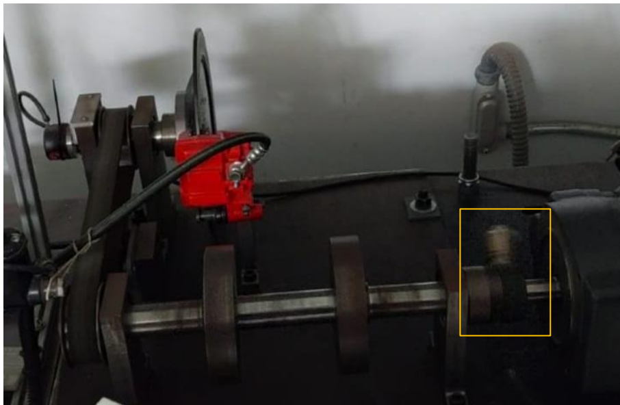
Figura 4.3: Cople con masa independiente para generar falla por desbalance (autoría propia).
