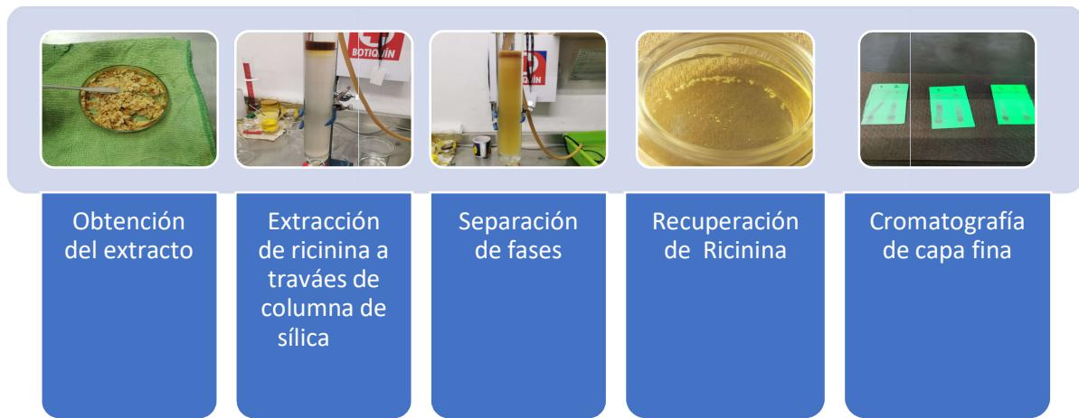
**Figura 15.** Proceso de extracción de muestra para análisis de cromatografía de columna abierta y chromatoplaca para identificación de ricinina. Fuente: Elaboración propia.
