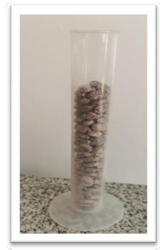
**Figura 13.** Determinación de peso volumétrico de semillas. Fuente: Elaboración propia
