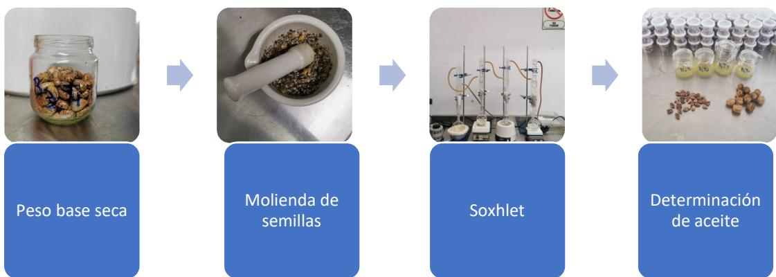
**Figura 14.** Proceso extracción de aceite en semillas por método Soxhlet. Fuente: elaboración propia
