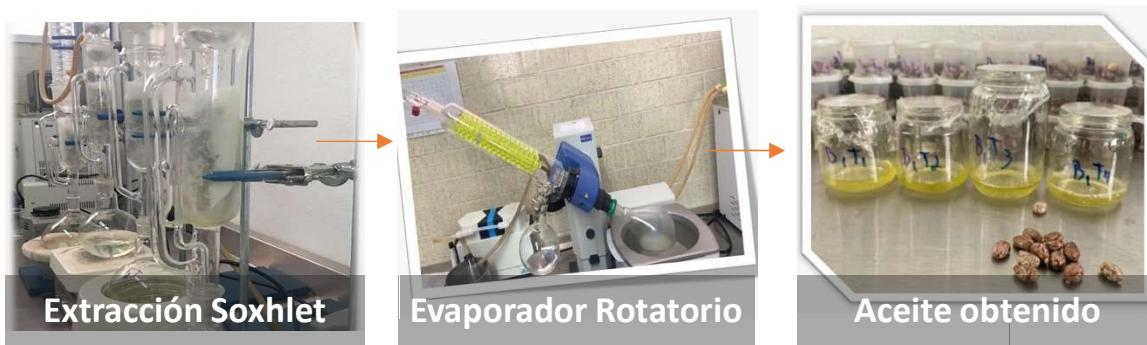
**Figura 20.** Proceso de extracción de aceite en semillas. Fuente: Elaboración propia.
