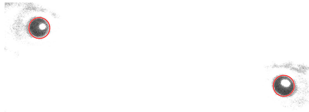
Figura 10.11: Región identificada de las pupilas mediante el algoritmo propuesto, en la imagen pre-procesada del Caso 1.
