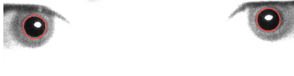
Figura 10.22: Región identificada de las pupilas mediante el algoritmo propuesto, en la imagen pre-procesada del Caso 2.
