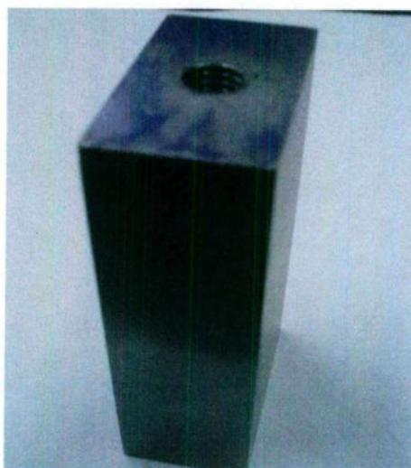
Figura 27. Dispositivo utilizado para la sujeción de probetas redondas de tensión, fabricado en las instalaciones del Instituto Mexicano del Transporte (Fotografía tomada por el autor).
