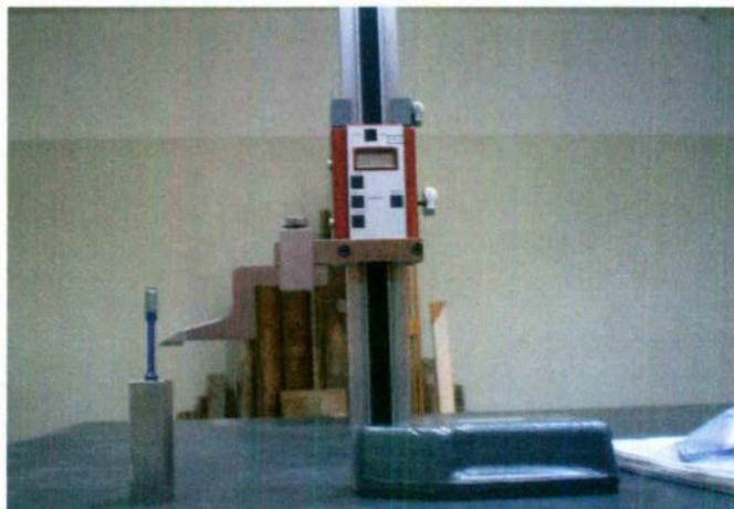
Figura 25. Uso del vernier de alturas para el rayado de probeta redonda de tensión
