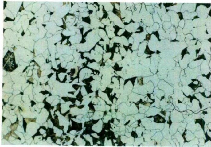
Figura 53. Fotomicrografía que muestra la microestructura en la dirección transversal, atacada con Nital al 3%, 200x.
