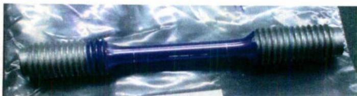
Figura 26. Probeta de tensión redonda (Fotografía tomada por el autor).
