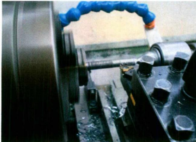
Figura 23. Tallado de cuerdas en torno EMCO para probetas de tensión redondas
