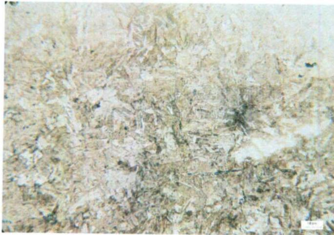
Figura 67. Microestructura correspondiente a la temperatura de 820°C. 1000x.
