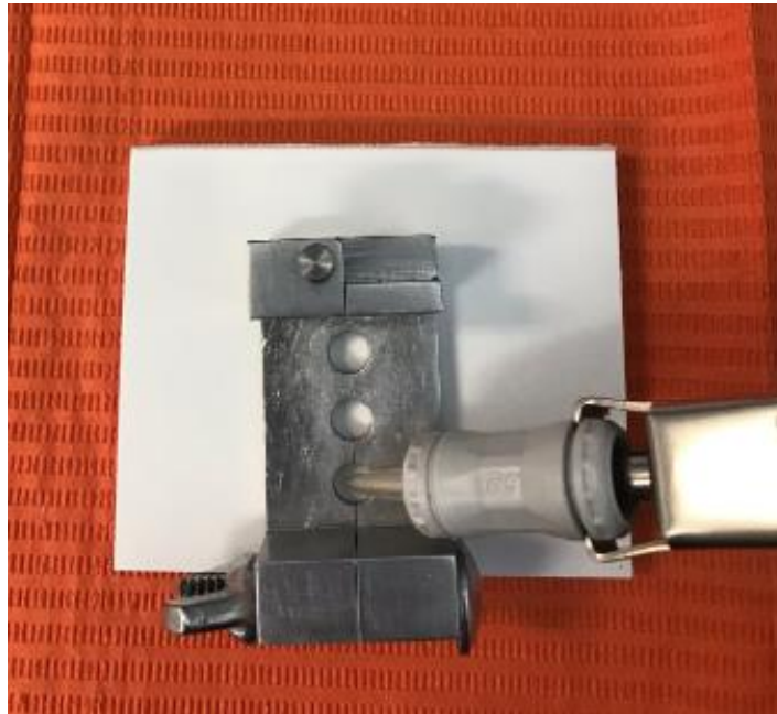
Figura 8. Capsula de Equia Forte® Fil en molde
