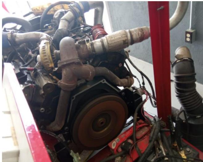
*Figura 9: Motor turbo-Diésel Ford de 7.3L (Propia)*
