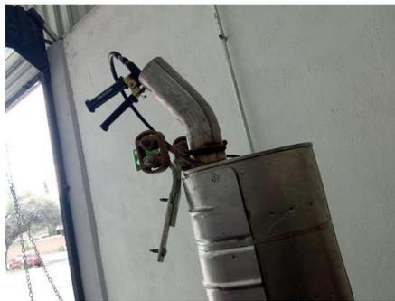
*Figura 14: Escape con sonda (Propia)*
