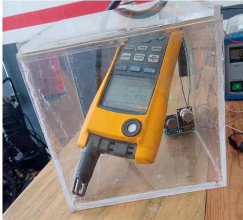
*Figura 7: Medidor de calidad del aire, FLUEKE 975 AIRMETER (Propia)*
