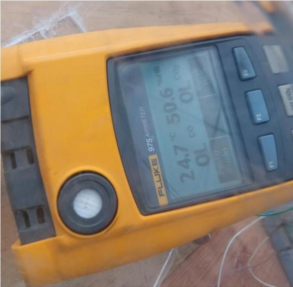
Figura 15: Valor en partes por millón (PPM) (Propia)
