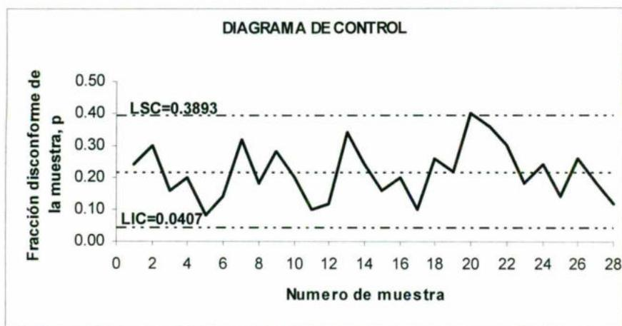
Figura 3-2 Diagrama de control eliminando las muestras 15 y 23 de la tabla 3-1
