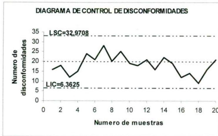
Figura 3-5 Diagrama de control de disconformidades de la tabla 3-4
