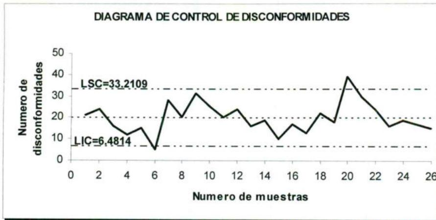
Figura 3-4 Diagrama de control de disconformidades de la tabla 3-3
