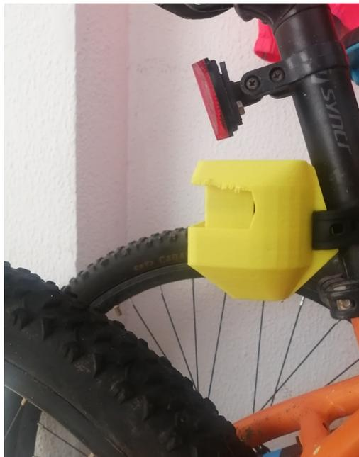
*Figura 58: Prototipo dimensional "Visión" adaptado al tubo del sillín de la bicicleta (Autoría propia, 2021).*
