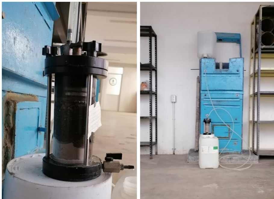
Figura 3.4. Prototipo 1 modelo de sufusión
