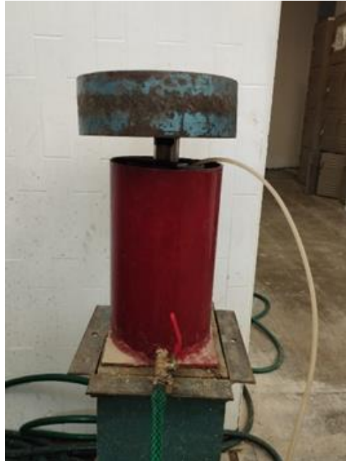
Figura 3.8. Modelo de sufusión durante corrida experimental con muestra
