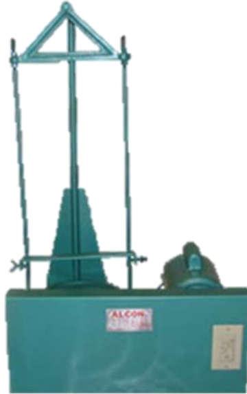
Figura 3.2. Agitador mecánico de tamices de la marca ALCON
