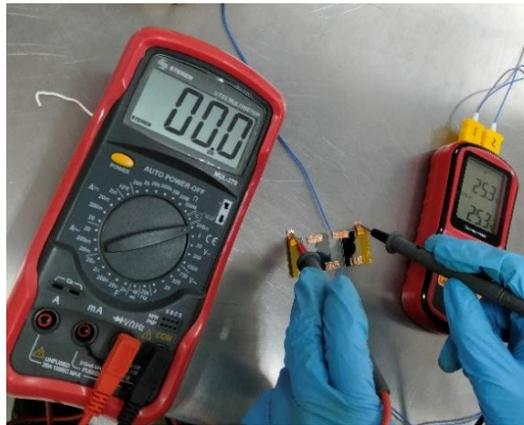
**Figura 43.** Prueba con  $\Delta T = 0$  K.
