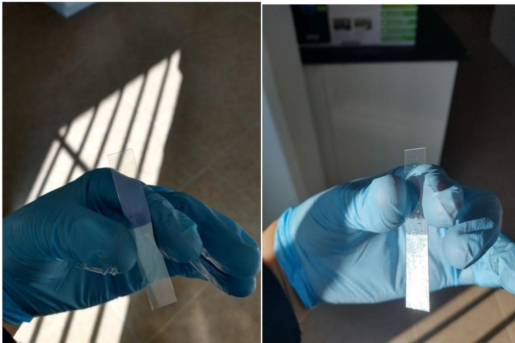
*Ilustración 39* Traslucides de las películas PET/ITO/ZnS:Mn depositadas
