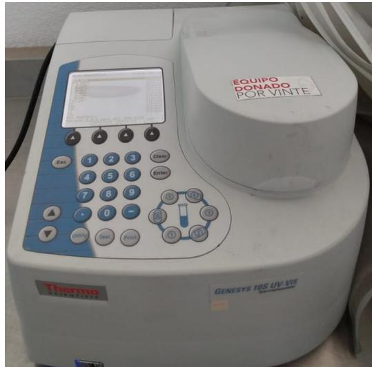
*Ilustración 16 Espectrofotómetro UV-Vis*
