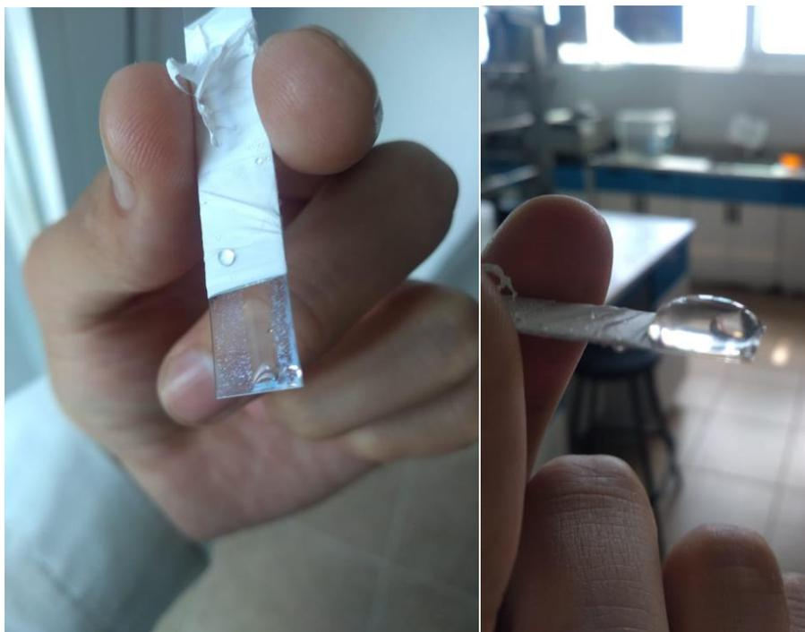
*Ilustración 57 Película después de ser sometida a varias pruebas de cronoamperometría y de ciclo voltamperometría*
