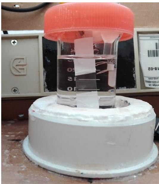
*Ilustración 18 Arreglo de 3 electrodos para pruebas electroquímicas. Electrodo de trabajo de ITO/ZnS:Mn cubierto con teflón para mantener una área de trabajo de  $1\text{cm}^2$ . Electrodo de referencia de Calomel Saturado y contraelectrodo de Pt. Lampara de UV de 365nm.*
